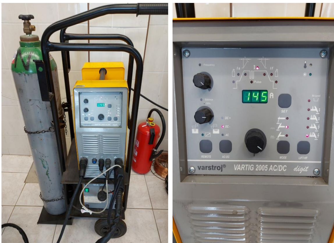
Slika 5.1 Varstroj VARTIG 2005 AC/DC uređaj za zavarivanje
