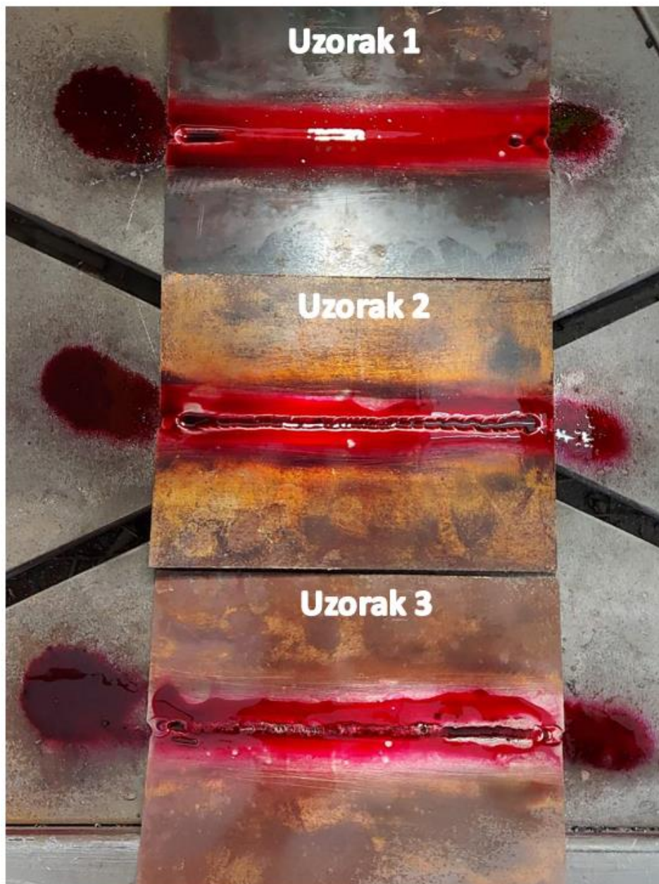
Slika 5.12 Nanošenje crvenog penetranta na uzorke
