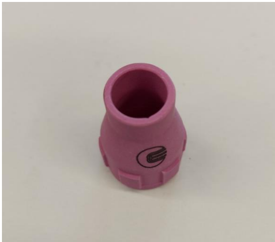
Slika 5.4 Keramička sapnica i pripadajuća deklaracija
