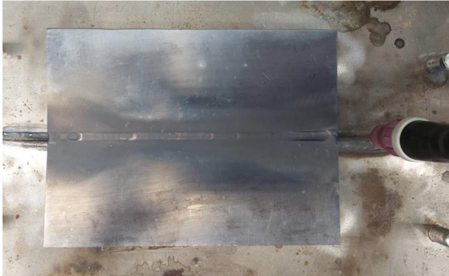
Slika 5.8 Uzorak 1 nakon zavarivanja
