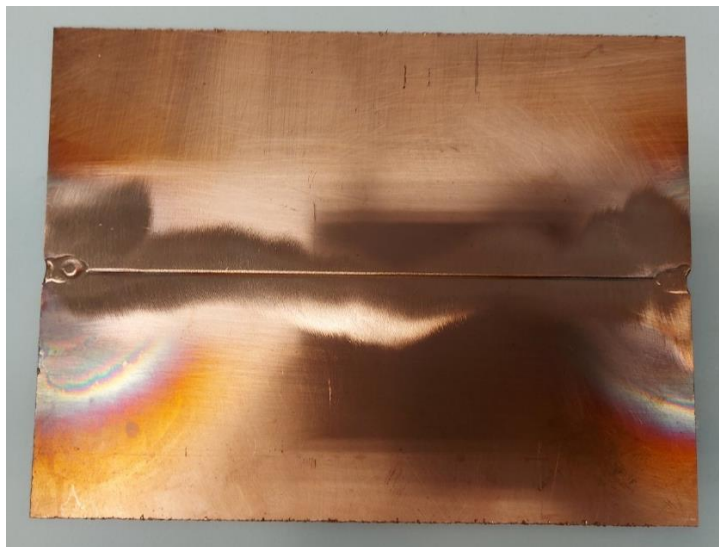
Slika 5.7 Uzorak pripremljen za zavarivanje
