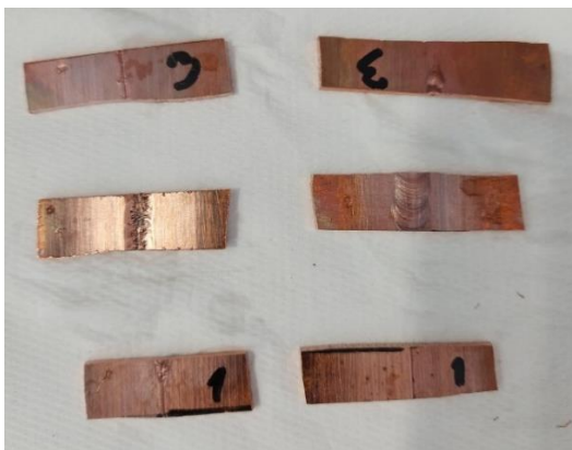
Slika 5.15 Izrezani uzorci za makro izbrusak
