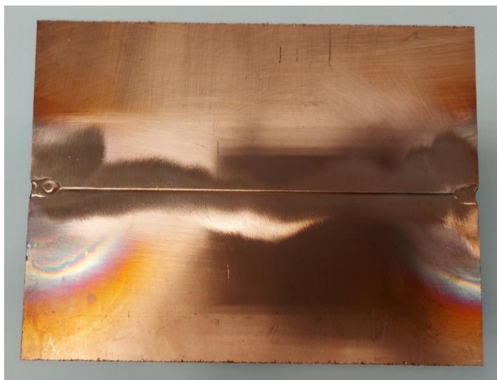
Slika 5.7 Uzorak pripremljen za zavarivanje
