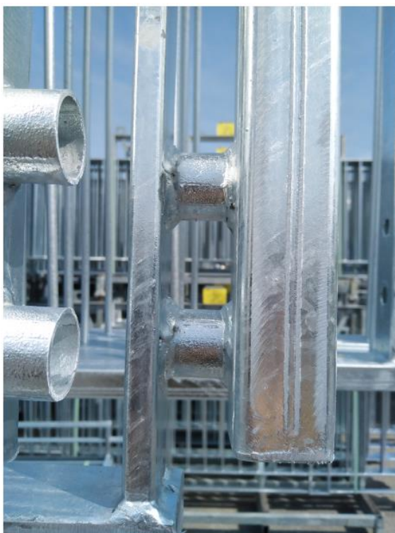
Slika 56: Zavareni "Segment" s stupom nakon cinčanja [11]
