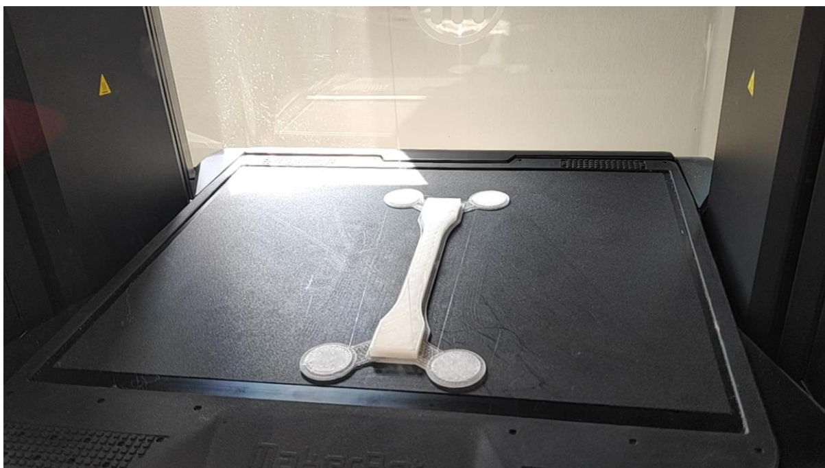
Slika 33. Završna faza - gotova epruveta
