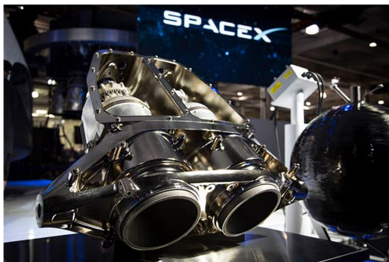
Slika 15. 3D tiskani "The SuperDraco" motor tvrtke SpaceX [22]
