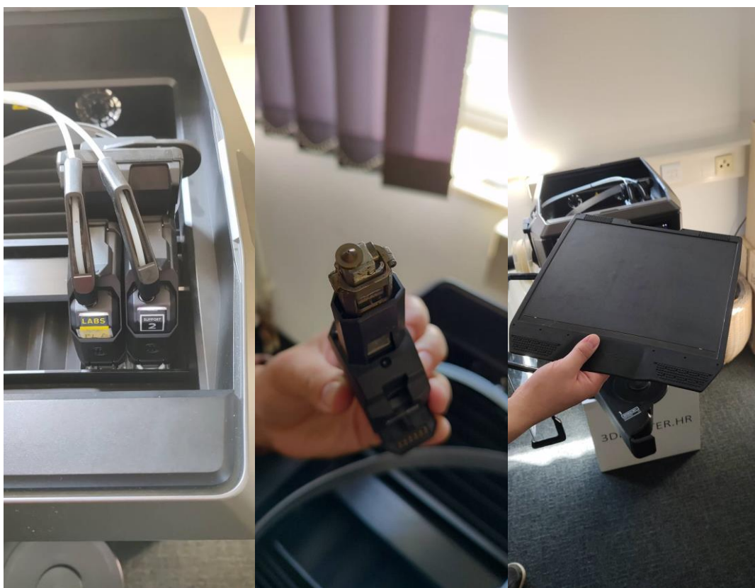
Slika 30. a) ekstruderi b) mlaznica c) radna podloga
