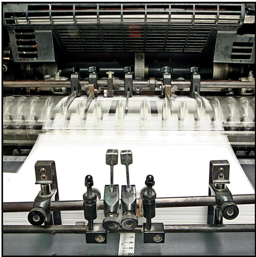
Slika 4. Heidelberg Speedmaster, četverobojni stroj B2 – ulagača jedinica [16]
