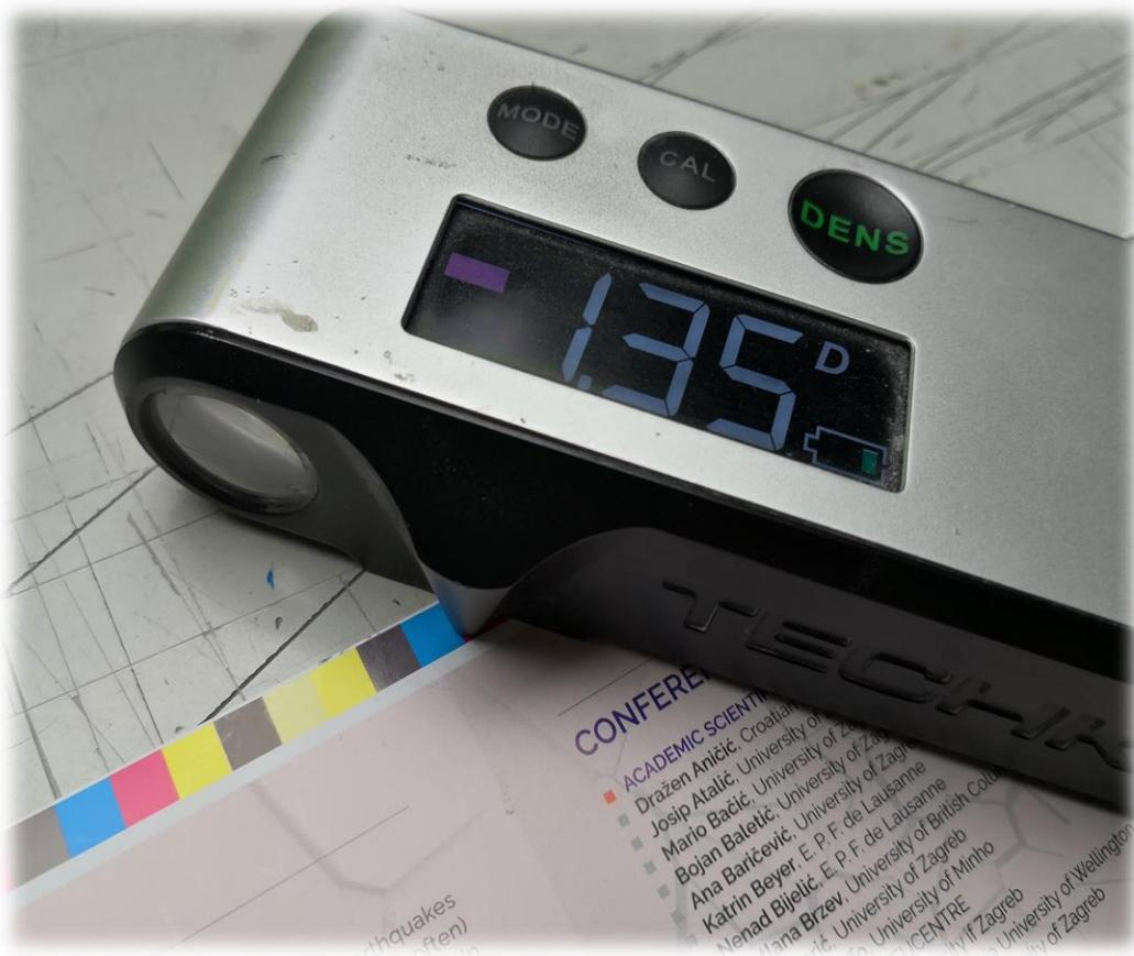
Slika 15. Mjerenje klina (kontrolnog stripa) denzitometrom
