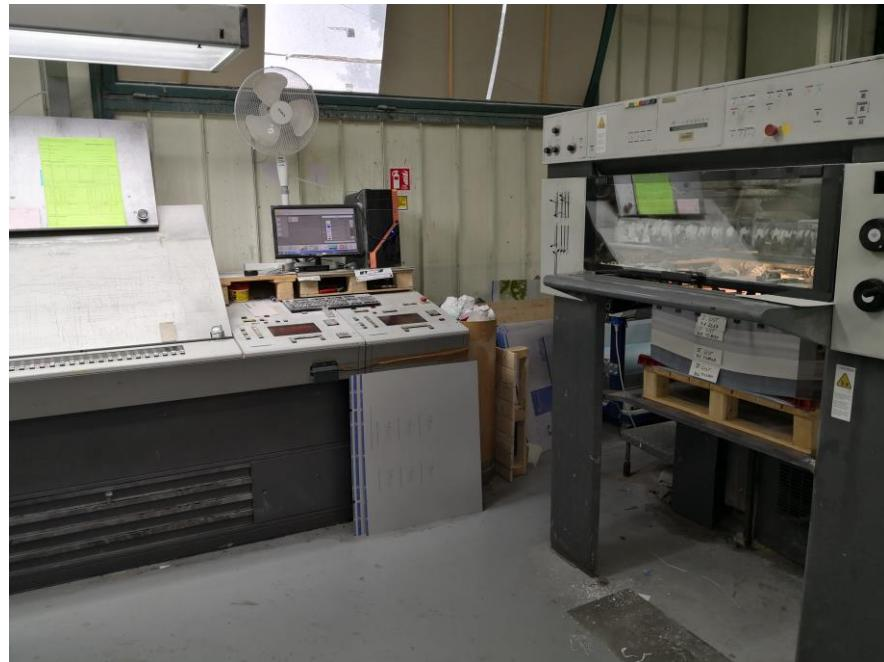
Slika 5. Heidelberg Speedmaster, četverobojni stroj B2 – izлагаča jedinica
