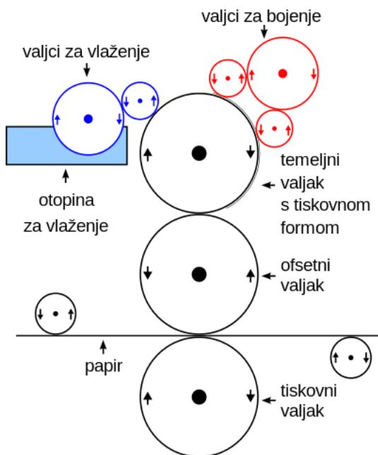
Slika 3. Princip rada ofsetnog tiska
