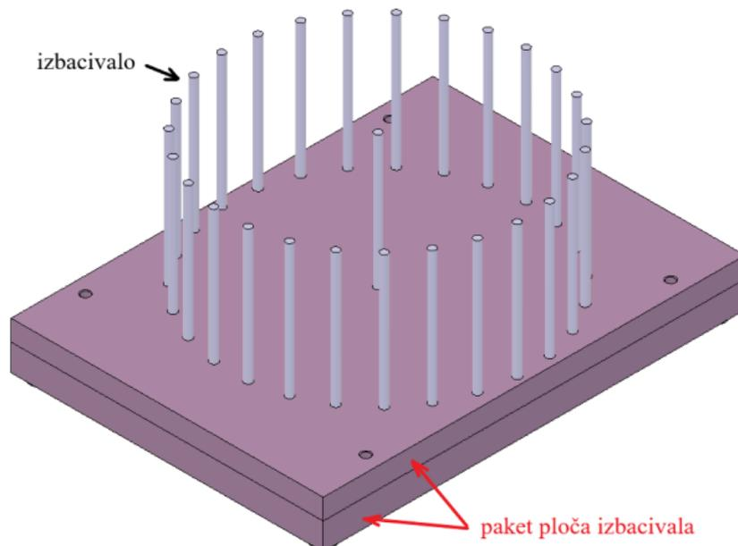
Slika 4.6.6.2. sustav za vađenje otpreska iz kalupa [17]
