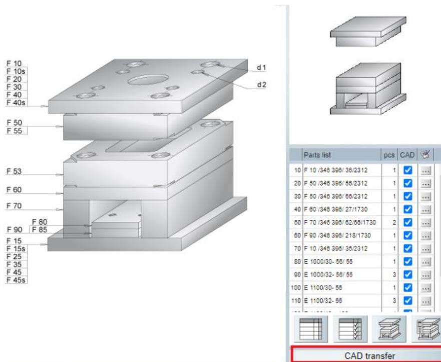
Slika 4.6.9.1. 3D model kalupa sa svim sastavnim dijelovima [21]
