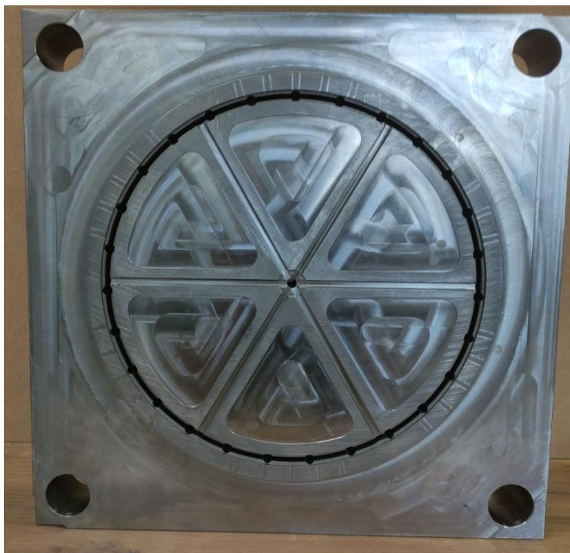
*Slika 4.9.2.2.2. ploča kalupne šupljine na pomičnom dijelu kalupa [41]*
