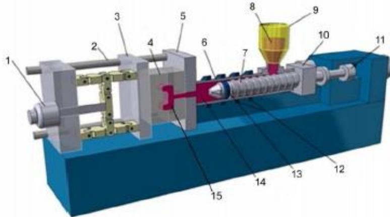
Slika 2.1. linija za injekcijsko prešanje polimernih materijala [1]
