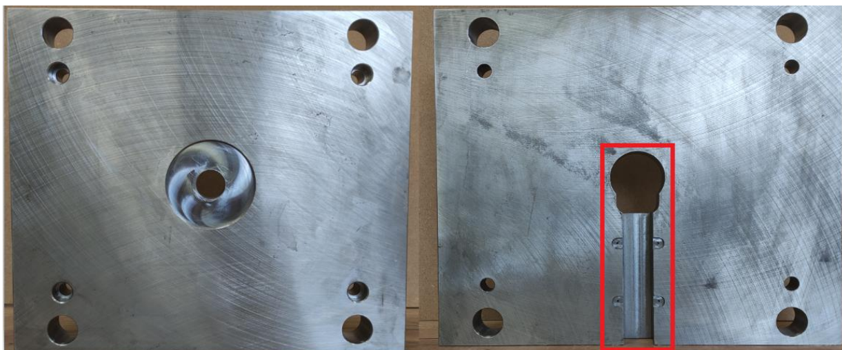
Slika 4.9.1.2. ploča kućišta kalupa prije i poslije strojne obrade [37]
