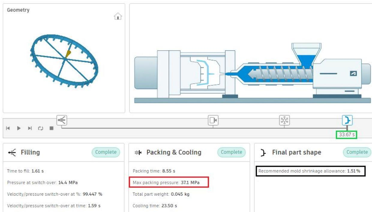
Slika 4.8.9.1. simulacija procesa injekcijskog prešanja zadanog otpreska [34]
