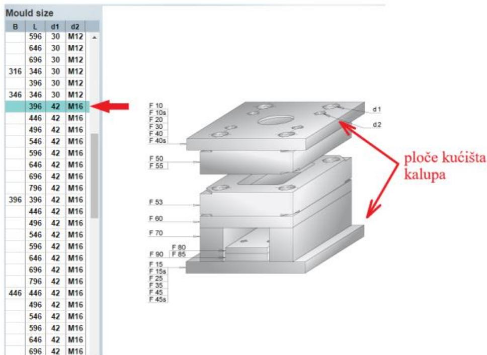
Slika 4.6.1.1. odabrano kućište iz baze standardnih elemenata kalupa [9]
