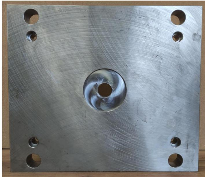
*Slika 4.9.1.1. ploča kućišta kalupa pomičnom dijelu kalupa [36]*
