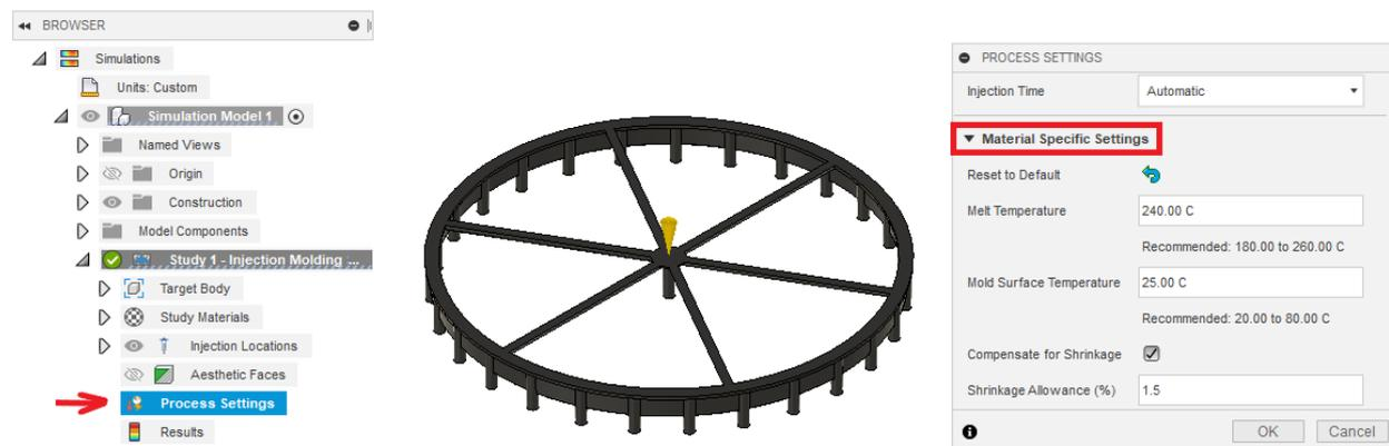
Slika 4.7.3.1. ulazni parametri za simulaciju procesa [25]
