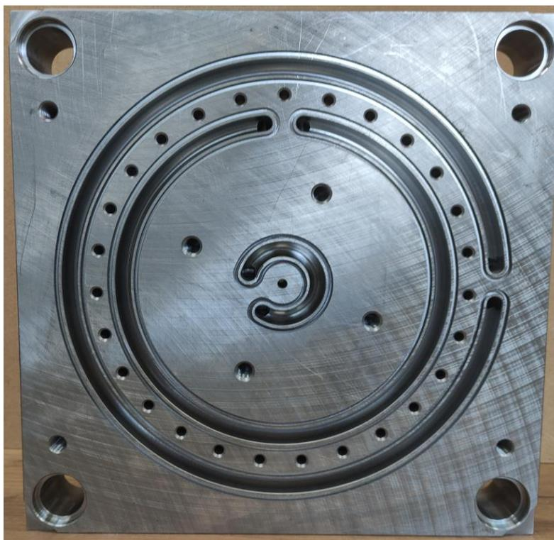
*Slika 4.9.2.2.1. krug za temperiranje ploče kalupne šupljine na pomičnom dijelu kalupa [40]*
