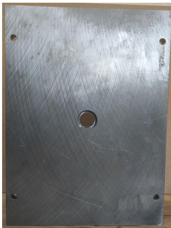
Slika 4.9.3.3.2. stezna ploča izbacivala [45]
