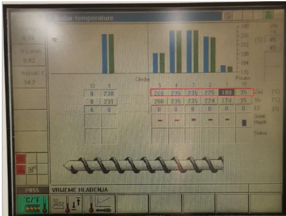
Slika 4.10.1. temperaturne zone cilindra ubrizgavalice [46]
