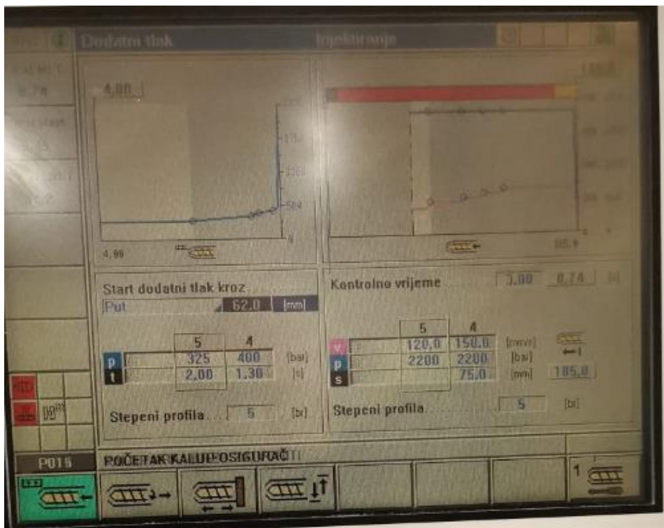
Slika 4.10.5. faza ubrizgavanja i djelovanja naknadnog tlaka [49]
