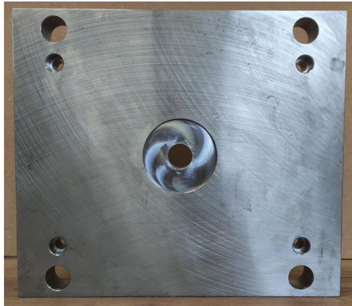
Slika 4.9.1.1. ploča kućišta kalupa pomičnom dijelu kalupa [36]
