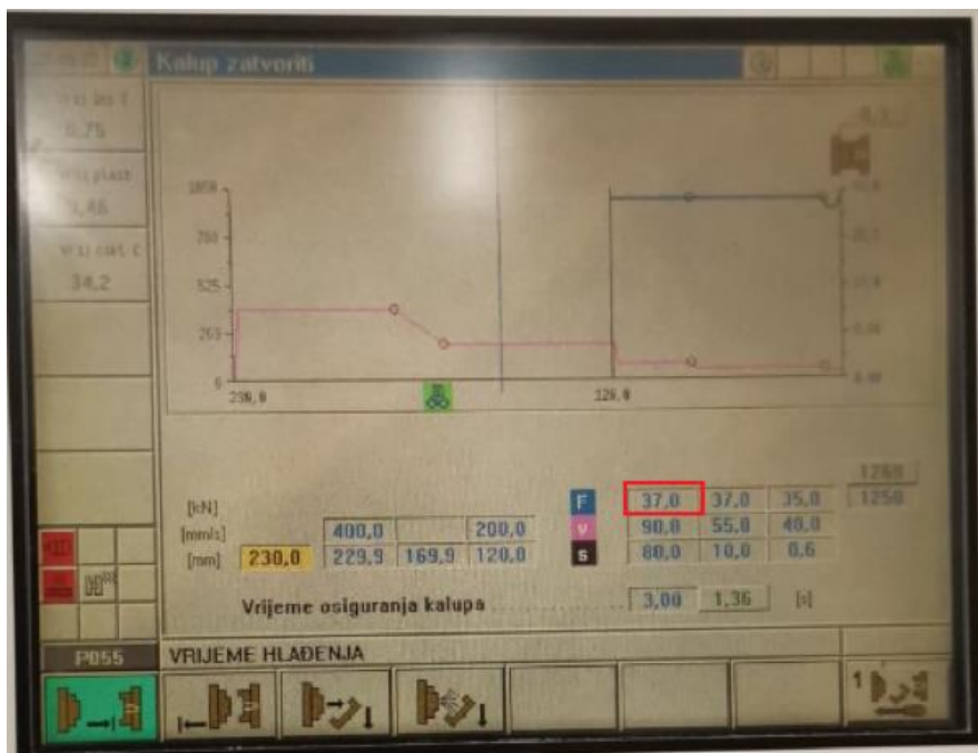
Slika 4.10.3. sila držanja kalupa [48]
