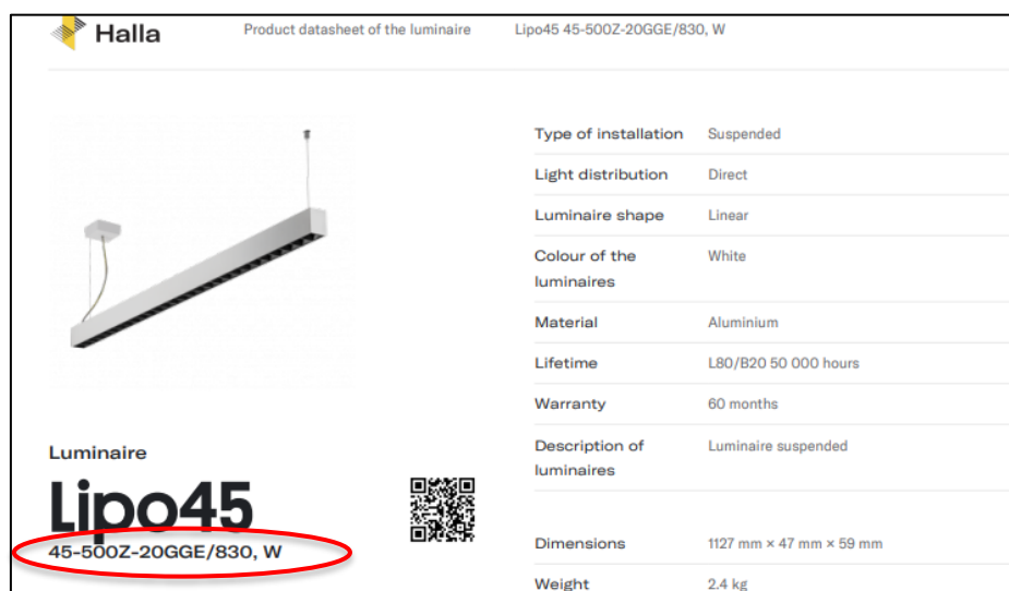
Slika 4.21 Šifra za pronalaženje LTD-a svjetiljke
