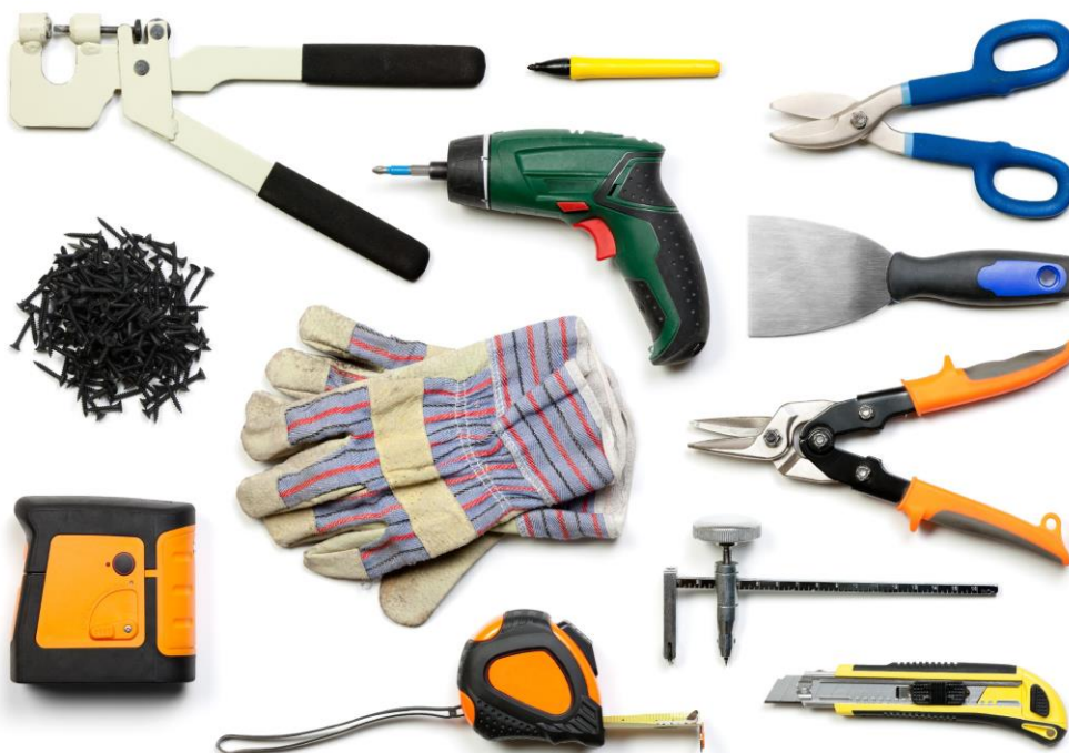
Slika 8. Osnovni alat i pribor za suhomontažnu gradnju [10]
