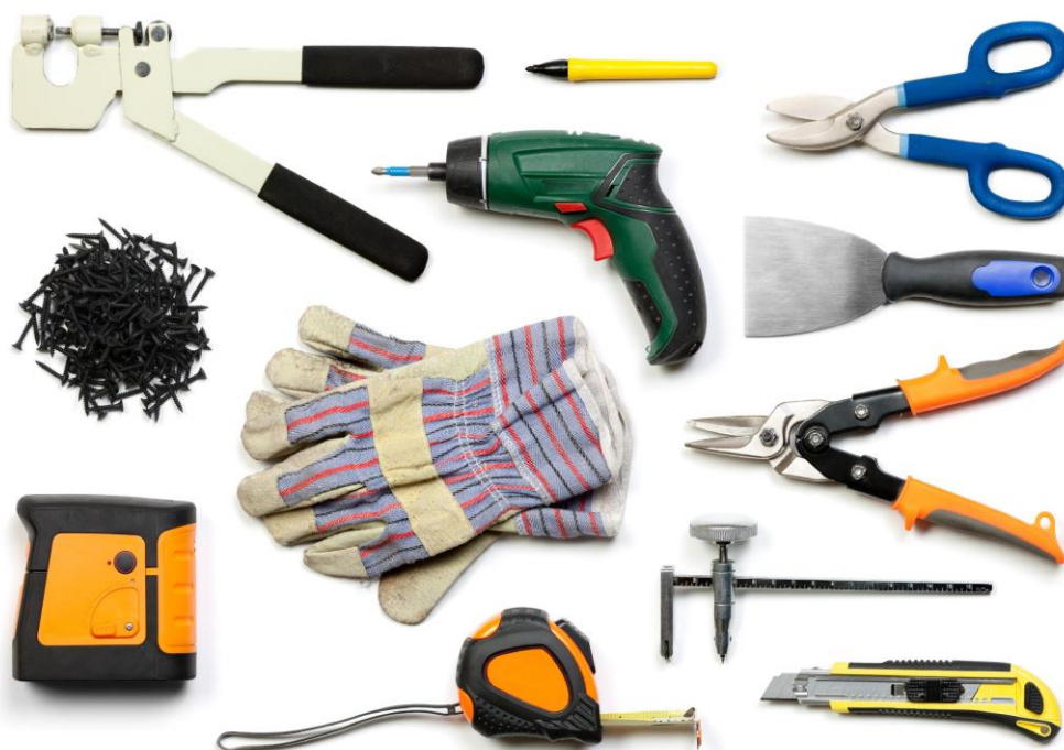
Slika 8. Osnovni alat i pribor za suhomontažnu gradnju [10]
