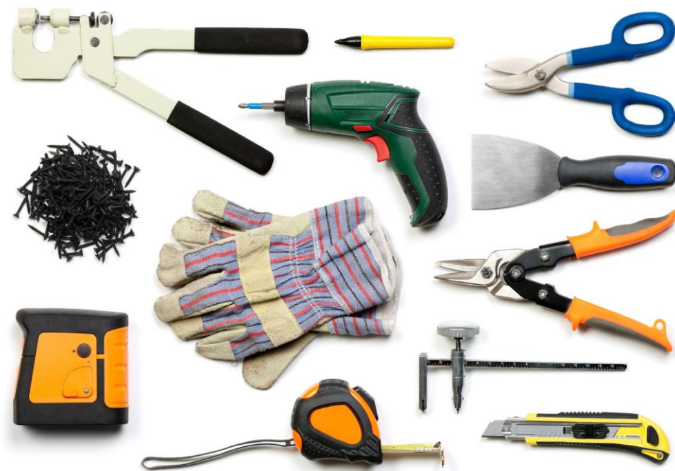
Slika 8. Osnovni alat i pribor za suhomontažnu gradnju [10]
