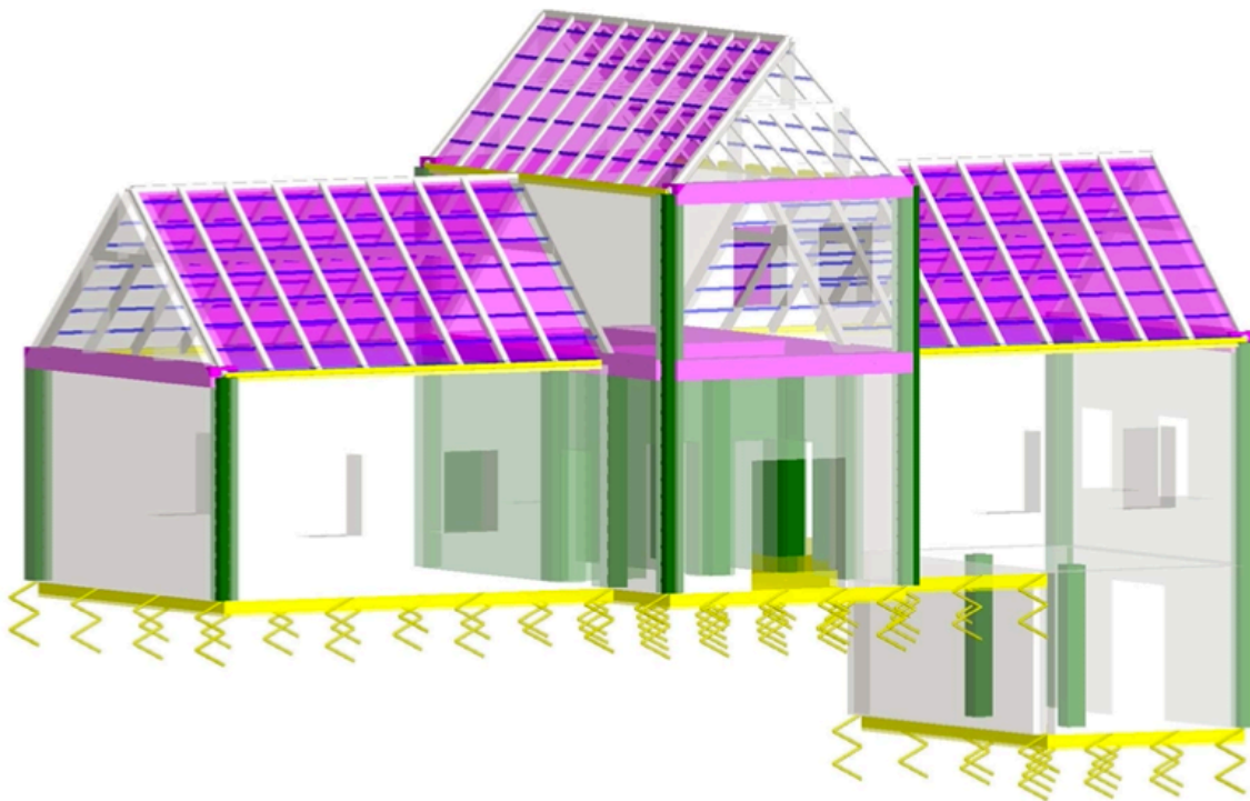
Slika 7.1. Prikaz predmetne građevine u programu Tower
