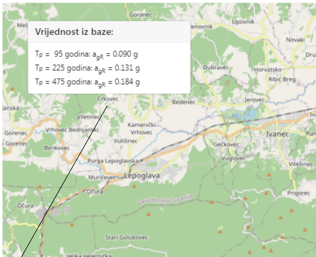
Slika 6.8. Parametar vršnog ubrzanja tla za promatranu lokaciju
