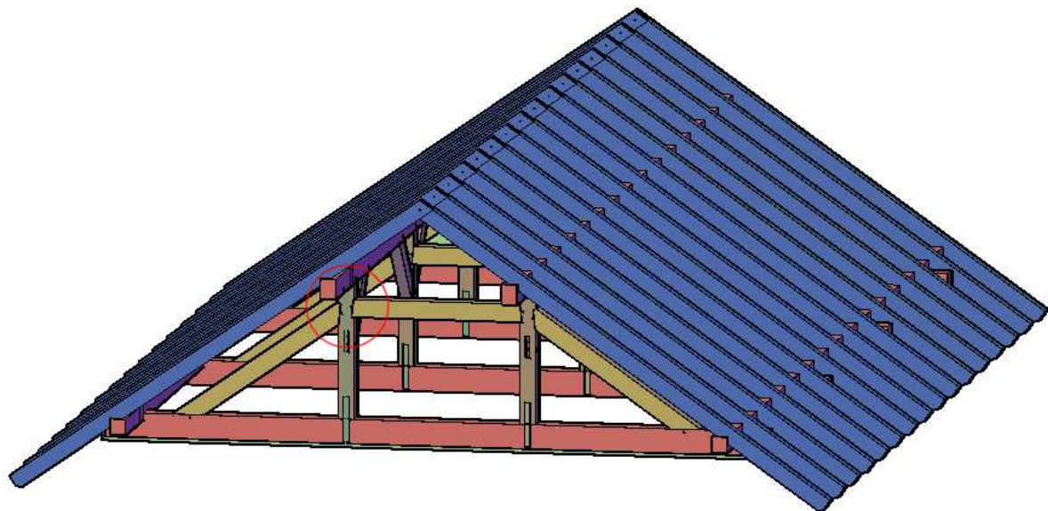
Slika 9.19 Spoj stupa i vezne grede – položaj veza
