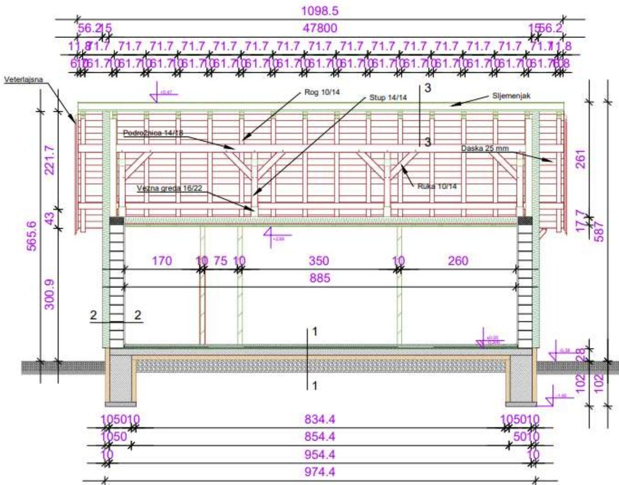
Slika 9.6 Uzdužni presjek
