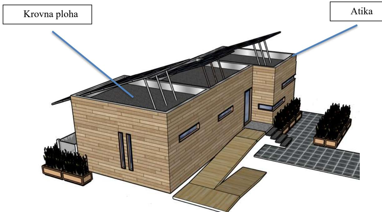
Slika 5.2 Dijelovi ravnog krova
