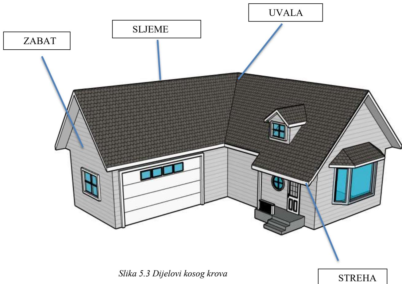
*Slika 5.3 Dijelovi kosog krova*
