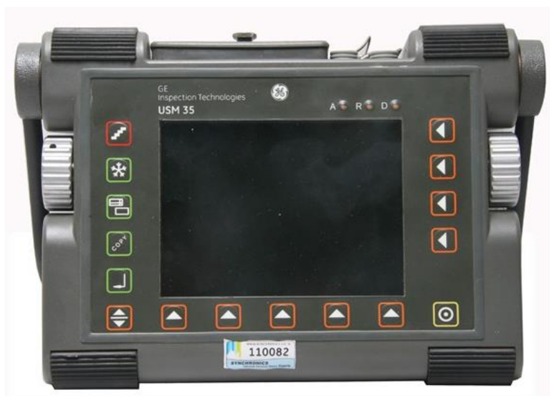
Slika 43. Ultrazvučni uređaj GE 35XS
