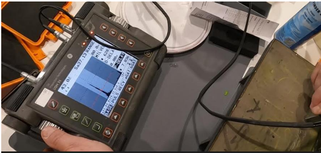
Slika 66. Skeniranje dvostrukom sondom
