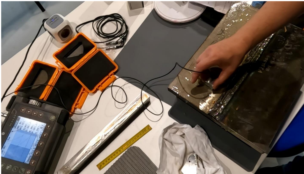
Slika 62. Skeniranje kutnom sondom od 60°
