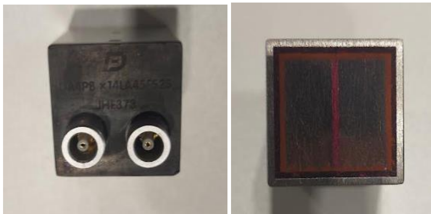
Slika 46. Dvostruka sonda JHE373
