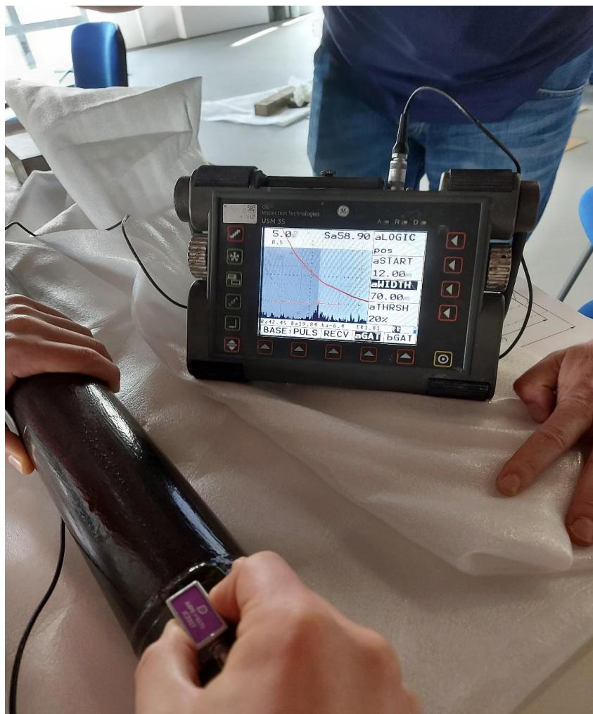
Slika 4. Ultrazvučna kontrola
