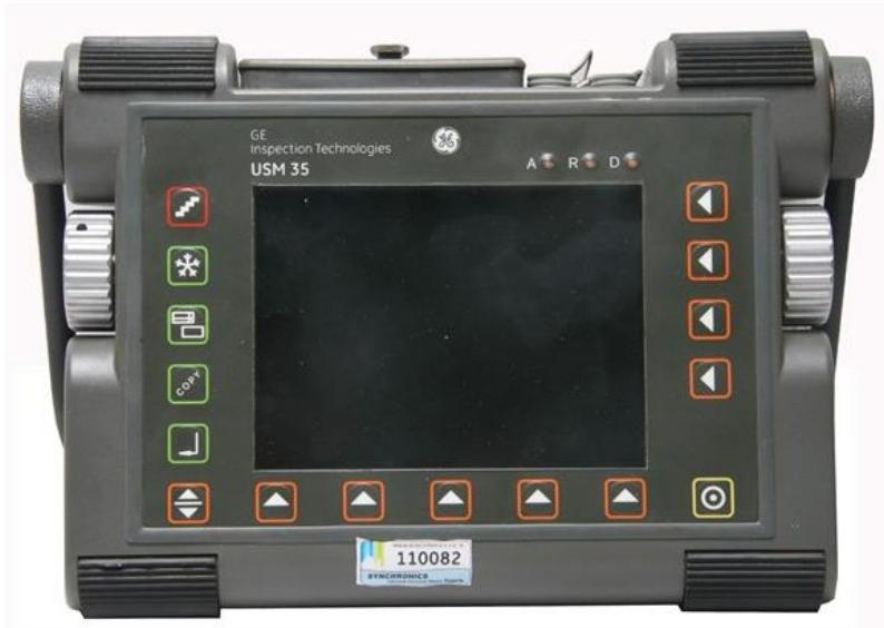
Slika 43. Ultrazvučni uređaj GE 35XS
