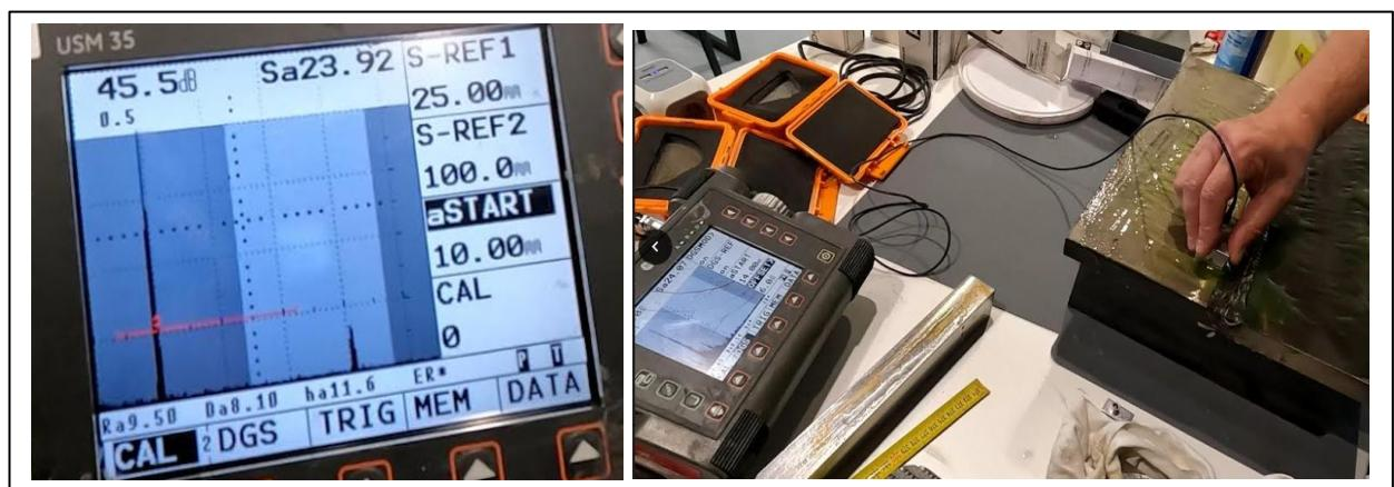
Slika 64. Baždarenje kutne sonde od 70° na ultrazvučni put na etalonu V2 (nehrđajući čelik) i skeniranje zavara po materijalu 1.4307
