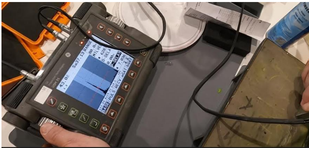
Slika 66. Skeniranje dvostrukom sondom
