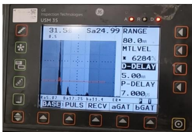
Slika 65. Baždarenje dvostruke sonde
