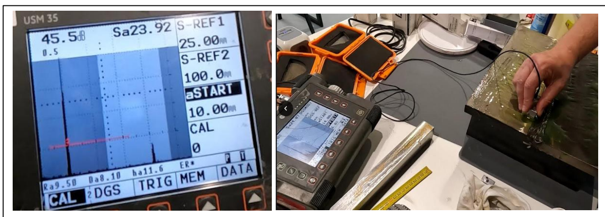
Slika 63. Baždarenje kutne sonde od 70° na ultrazvučni put na etalonu V2 (niskouglični čelik) i skeniranje zavara po materijalu S355J+N
