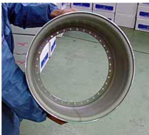
Slika 2.29 Zavarivanje trenjem rotirajućim alatom aluminijskih naplatka vozila [47]
