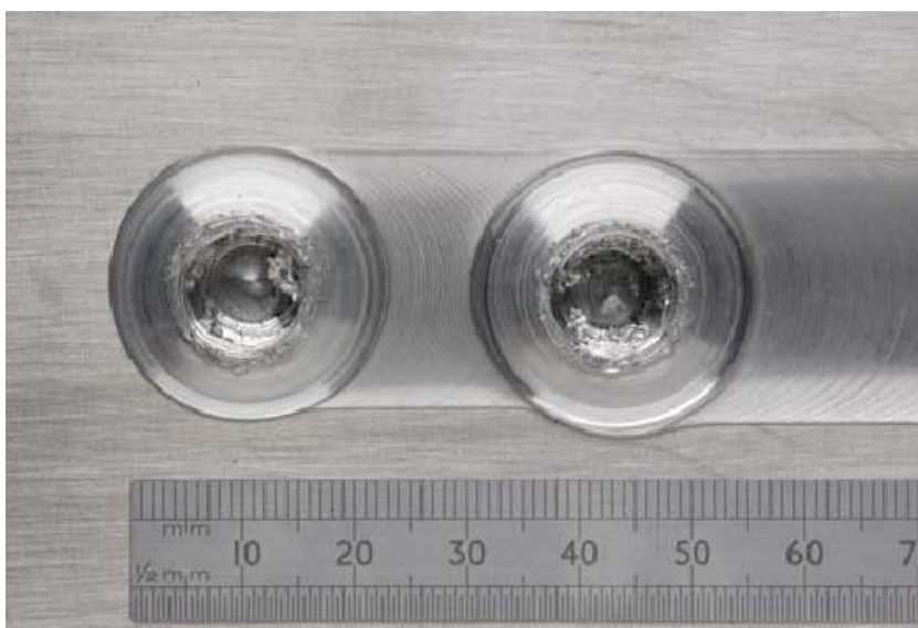
Slika 2.9 Provrt („ključanica“) na kraju zavarenog spoja [16]
