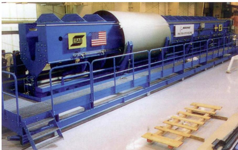
Slika 2.27 Boeing pogon za zavarivanje raketnih spremnika iz DELTA programa [16]
