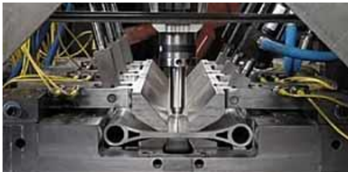
Slika 2.28 Zavarivanje trenjem rotirajućim alatom dijelova suspenzije vozila [47]
