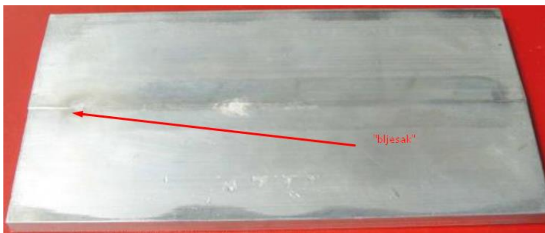
Slika 2.10 Prikaz donje strane zavara izrađenog FSW postupkom [17]
