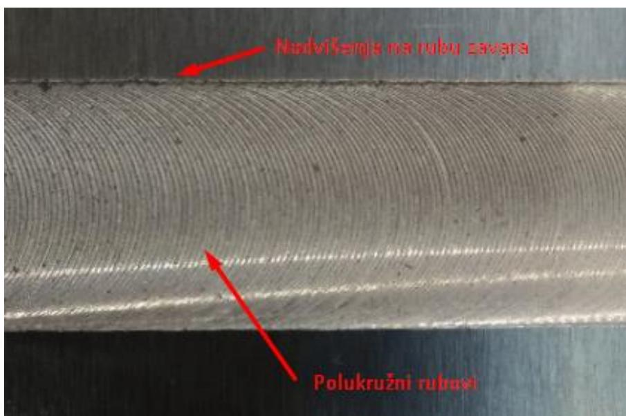
Slika 2.8 Izgled zavara nastalog zavarivanje trenjem rotirajućim alatom [15]
