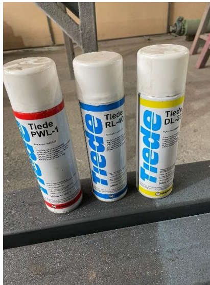
Slika 20. Penetranti (čistač, penetrant, razvijatelj)
