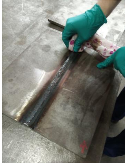
Slika 19. Čišćenje površine zavara
