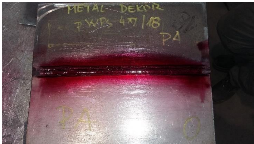
Slika 21. Nanesen crveni penetrant na zavareni spoj
