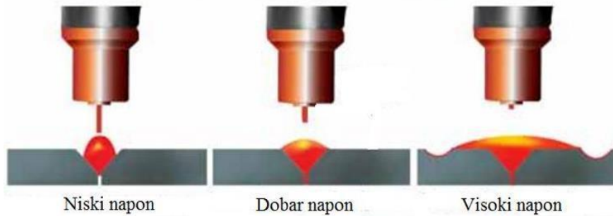
Slika 4. Utjecaj napona električnog luka U , V na geometriju zavara [3]
