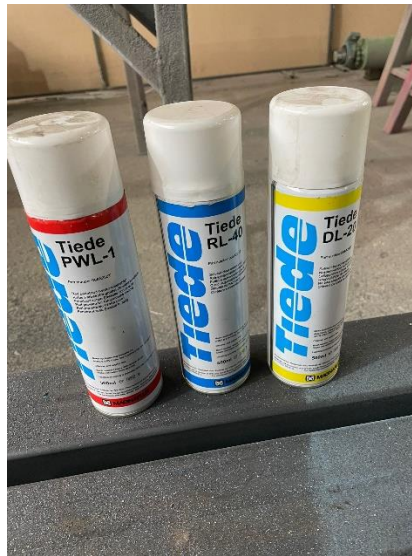
Slika 20. Penetranti (čistač, penetrant, razvijatelj)
