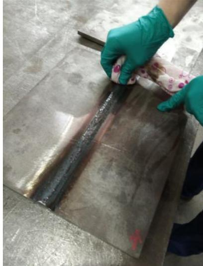
*Slika 19. Čišćenje površine zavara*
