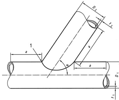
Slika 8. Ispitni uzorak za spoj cijevi (grana) [9]
