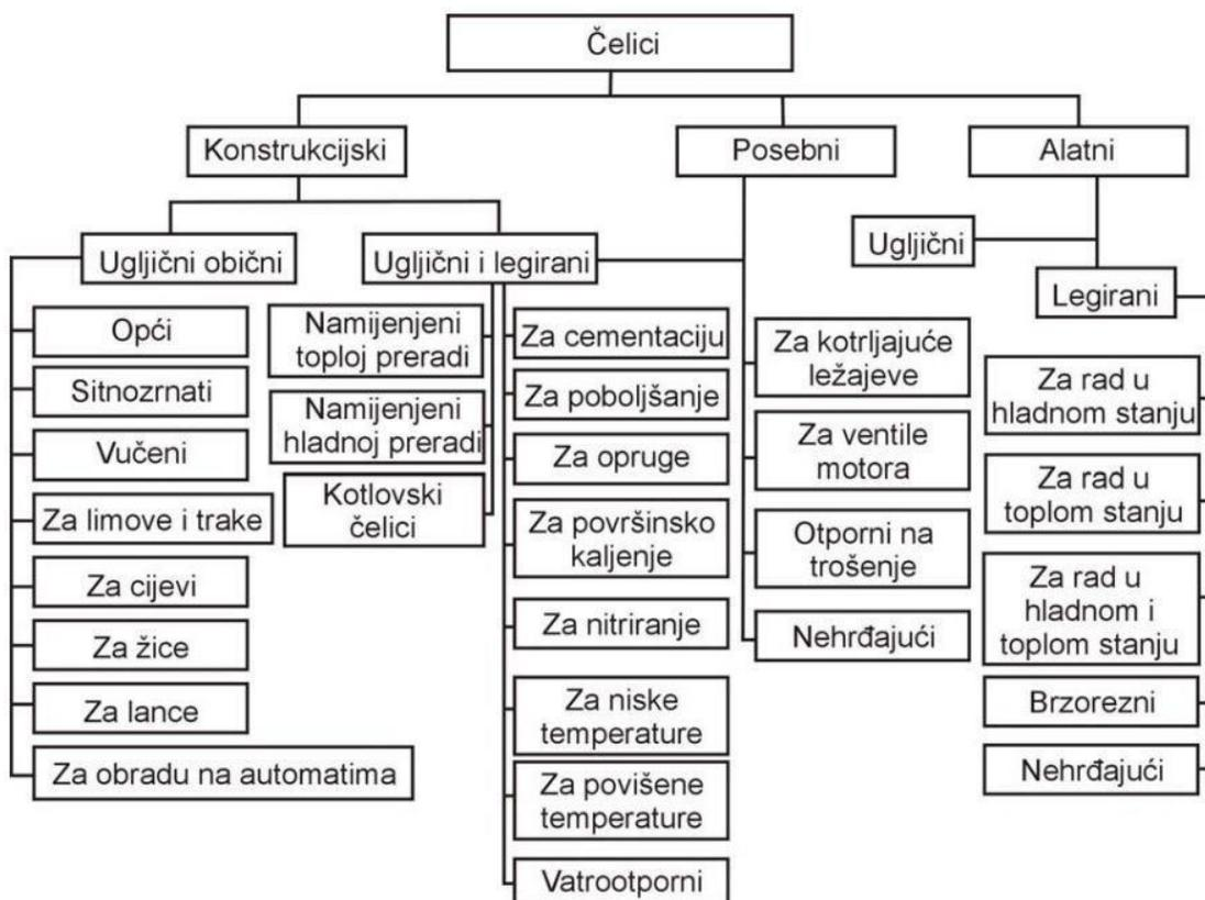
Slika 13. Opća podjela čelika prema namjeni [11]
