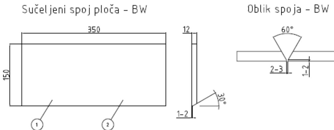
Slika 16. Izgled i dimenzija sučeljenog spoja dviju ploča
