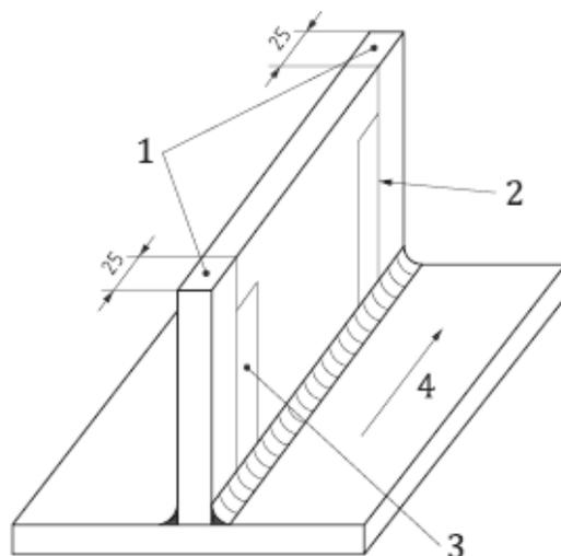
Slika 11. Položaj ispitnih uzoraka na T-spoju [9]
