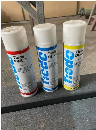
*Slika 20. Penetranti (čistač, penetrant, razvijatelj)*
