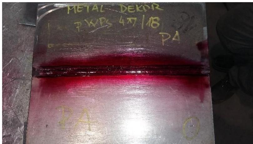
*Slika 21. Nanesen crveni penetrant na zavareni spoj*
