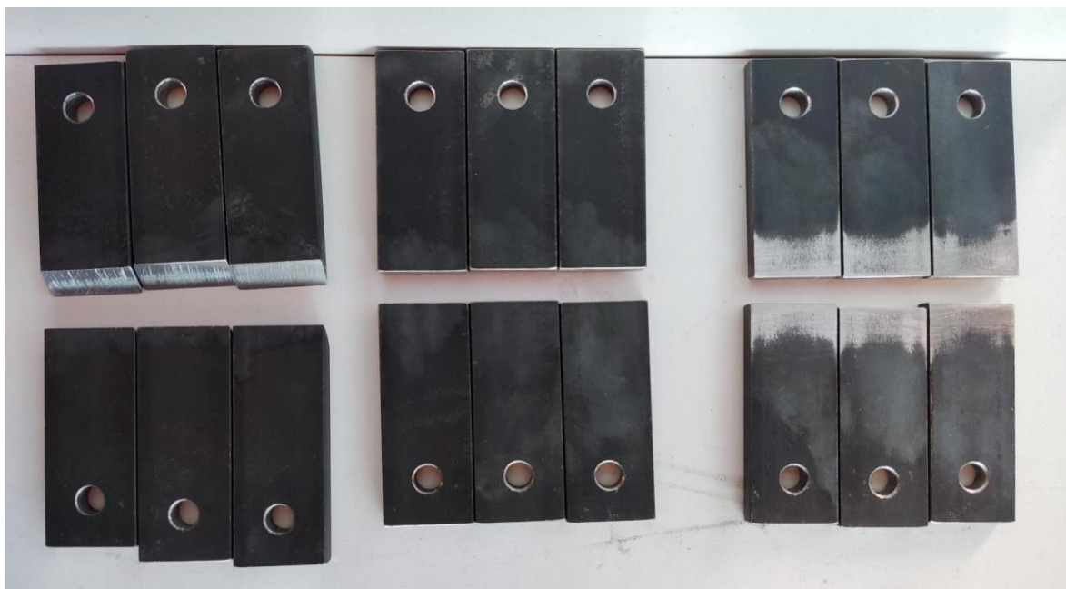
Slika 13 Pripremljeni materijal prije lijepljenja [autor Jurenec E., 17.10.2020.]
