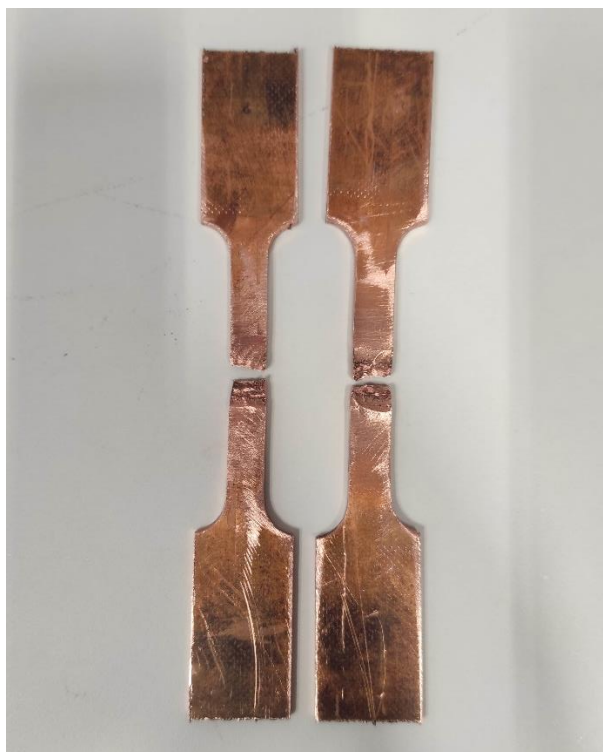
Slika 4.4.6 Epruvete nakon kidanja
