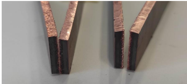
Slika 4.3.2 Savijanje lica zavara
