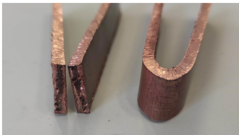
Slika 4.3.6 Savijanje lica zavora
