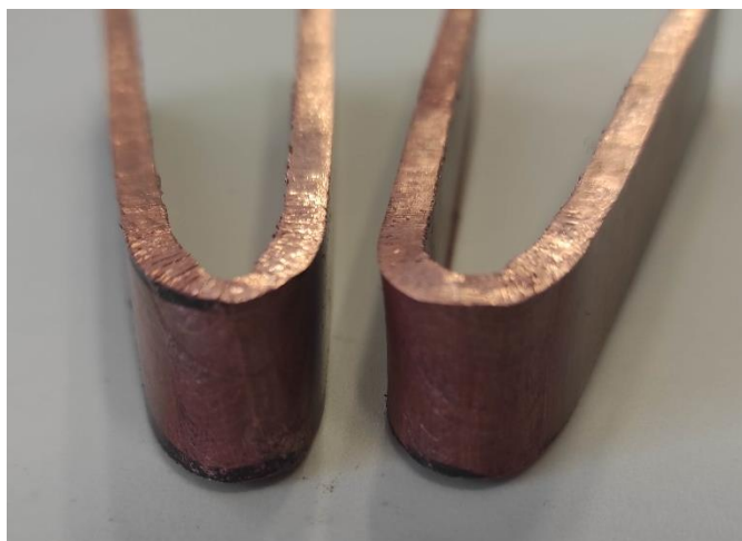
Slika 4.3.5 Savijanje korijena zavora
