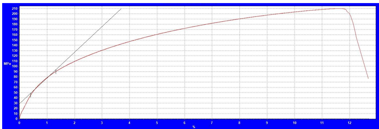
Slika 4.4.7 Dijagram naprezanje – pomak kidalice
