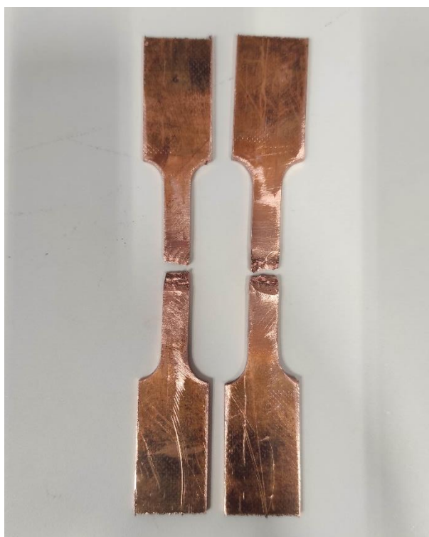
Slika 4.4.6 Epruvete nakon kidanja
