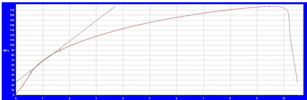
Slika 4.4.8 Dijagram naprezanje – pomak kidalice
