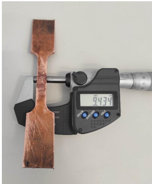
Slika 4.4.4 Širina paralelne dužine druge epruvete
