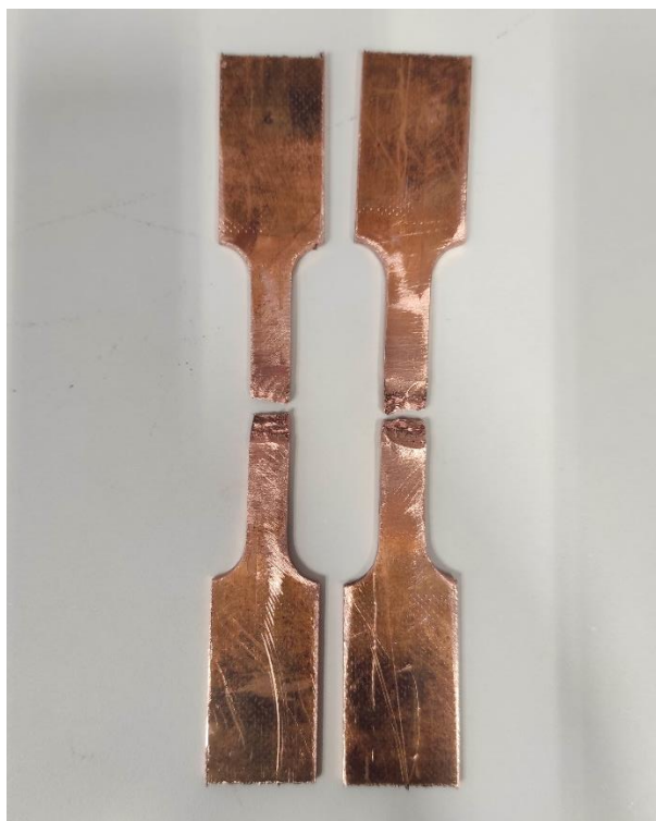
Slika 4.4.6 Epruvete nakon kidanja
