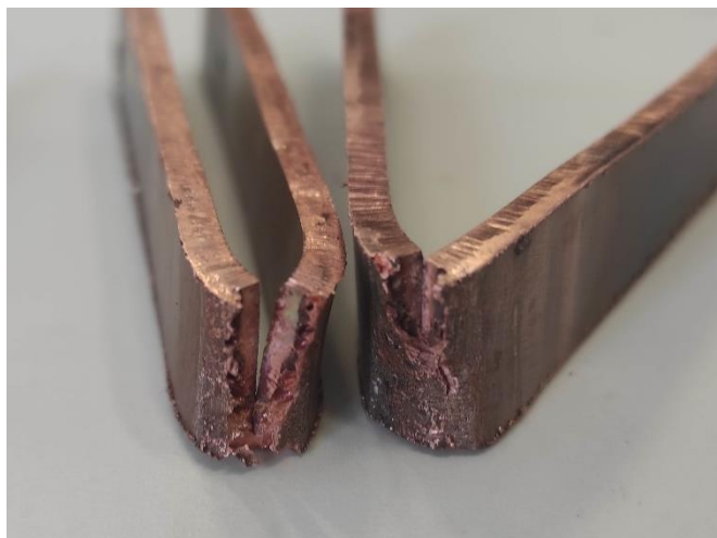
Slika 4.3.6 Savijanje lica zavora
