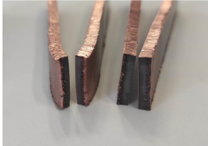
Slika 4.3.2 Savijanje lica zavara
