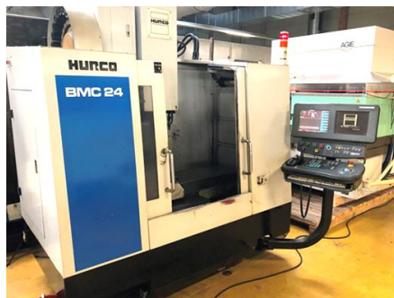
Slika 32. CNC glodalica Hurco
