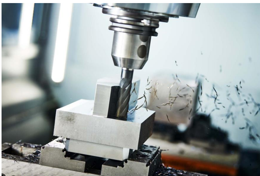
Slika 16. Gruba obrada glodanjem [8]
