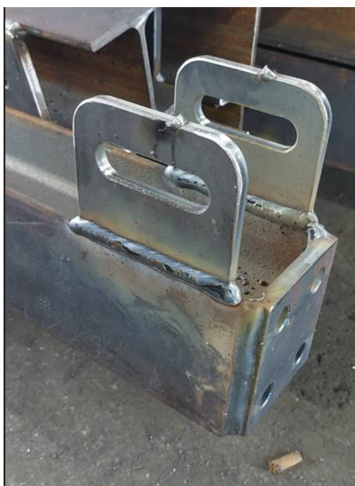
Slika 5.28 Prikaz sučelnog zavara
