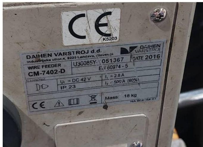
Slika 5.3 Karakteristike izvora za zavarivanje
