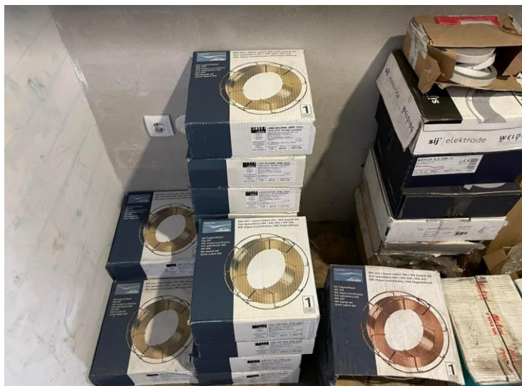
Slika 5.33 Skladištenje dodatnog materijala
