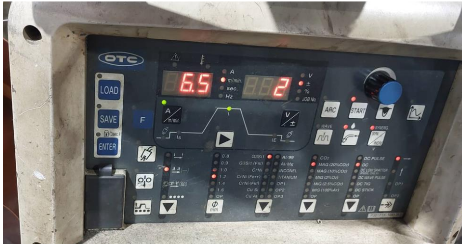
Slika 5.29 Parametri kod zavarivanja stupa konstrukcije
