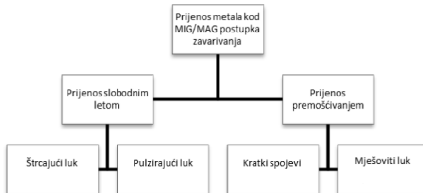
Slika 4.4 Mehanizam prijenosa metala kod MIG/MAG zavarivanja [11]
