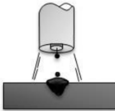
Slika 4.6 Prijenos metala pulsirajućim lukom [11]
