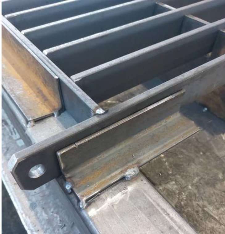
Slika 5.23 Detalj zavarene bočnice u šablona
