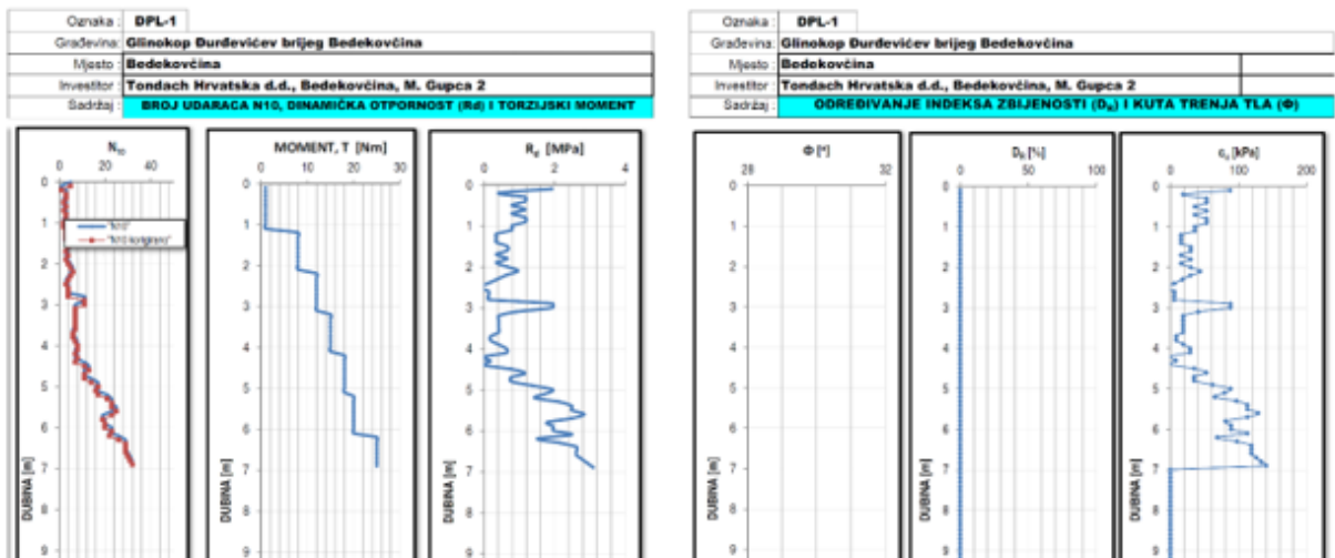
Slika 18: Rezultati dinamičke penetracije na poziciji DPL-1[1]
