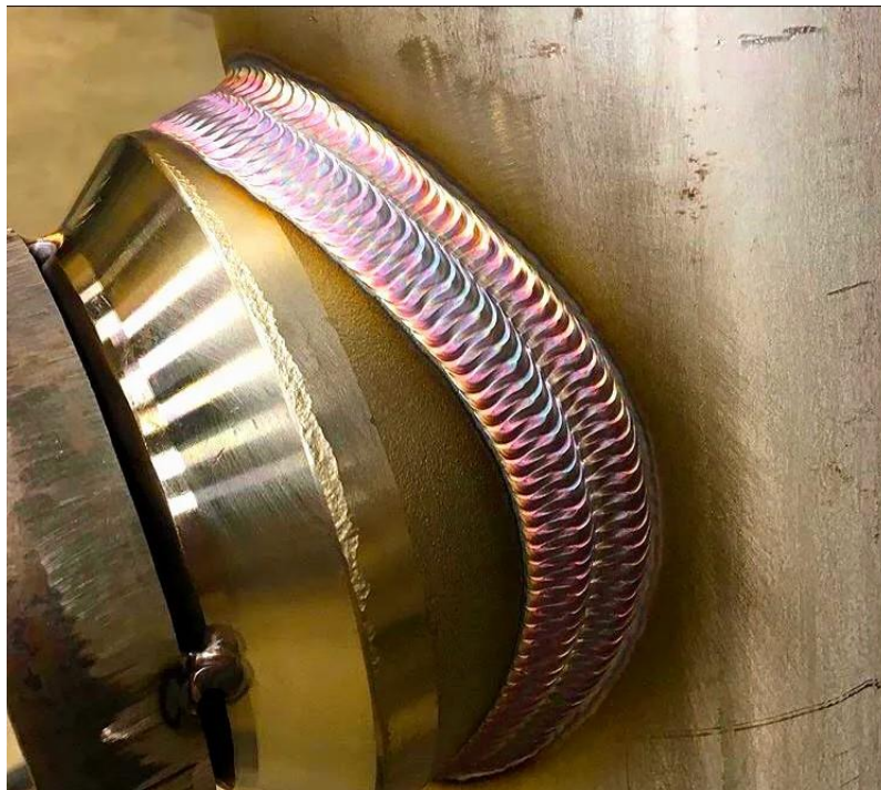
Slika 4. Izgled zavarenog spoja napravljen TIG postupkom [8]
