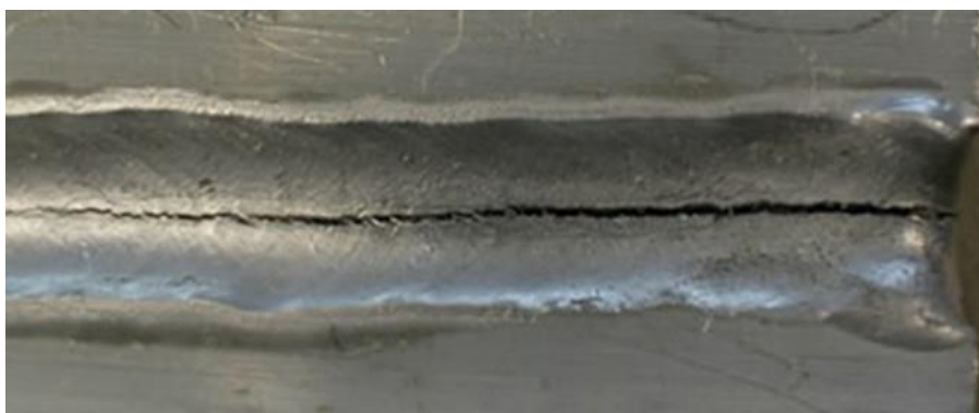
Slika 12. Pukotina u zavarenom spoju [12]
