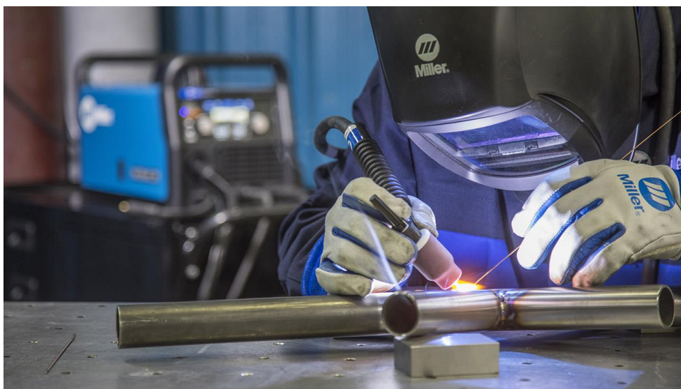
Slika 3. Zavarivanje TIG postupkom s dodavanjem dodatnog materijala [7]
