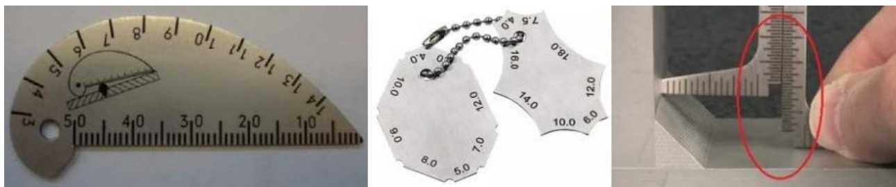
Slika 15. Mjerilo u obliku kapljice vode (lijevo), šablone za mjerenje visine kutnog zavara (sredina), HI- LO mjerna skala (desno) [13]
