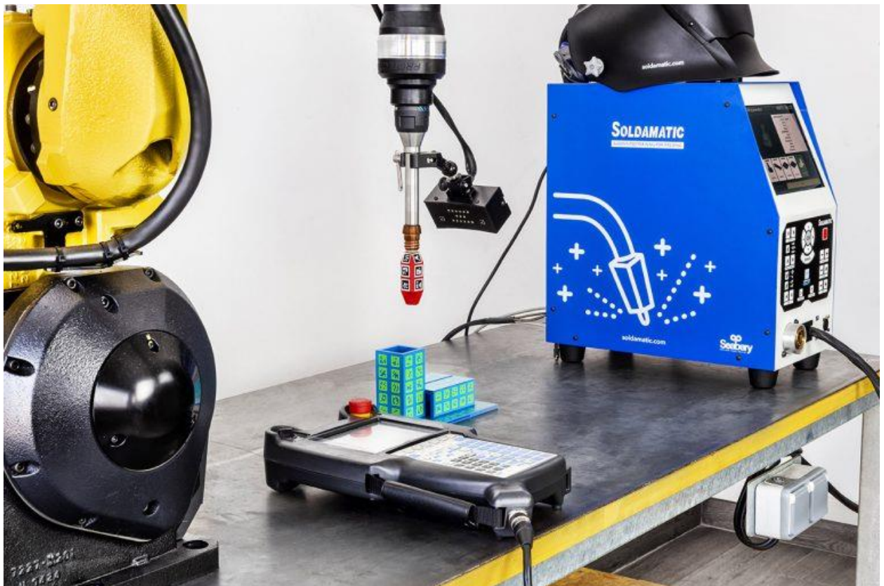
Slika 21. Programiranje robota pomoću Soldamatic simulatora za zavarivanje [24]
