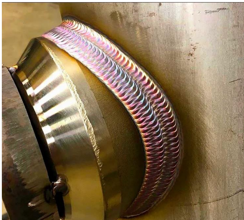
Slika 4. Izgled zavarenog spoja napravljen TIG postupkom [8]
