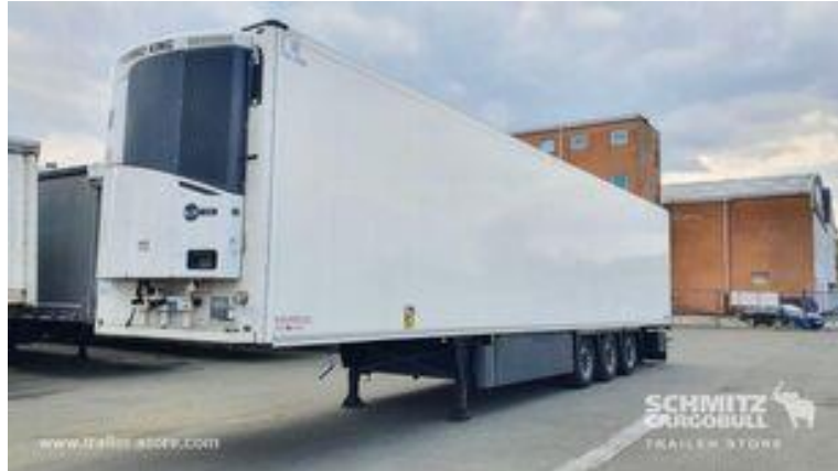
Slika 17: Poluprikolica hladnjača marke Schmitz
