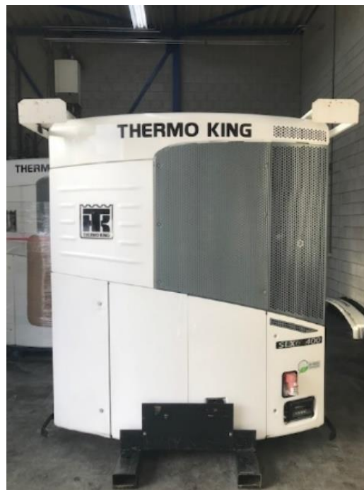
Slika 23: Rashladni agregat SLXi -400
