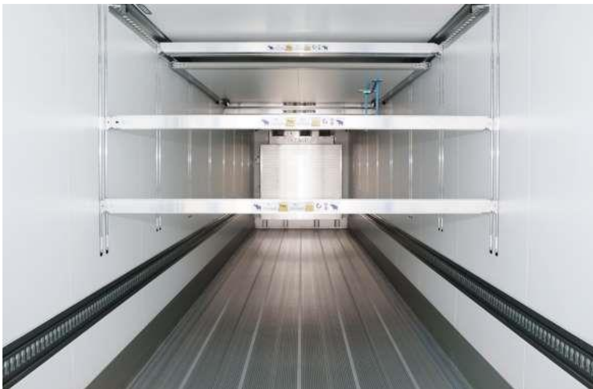
Slika 22: unutrašnjost poluprikolice hladnjače dupli nivo utovara
