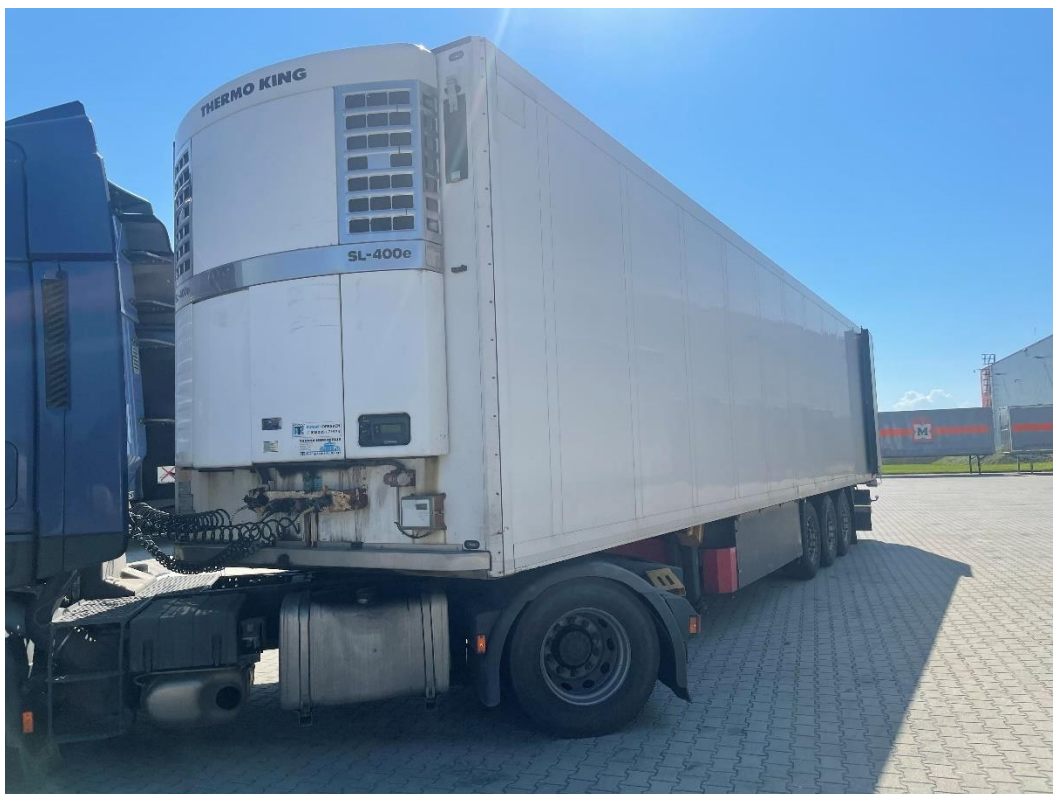
Slika 29: Poluprikolica hladnjača sa ThermoKing rashladnim agregatom (Marko-Trans Grupa d.o.o.)
