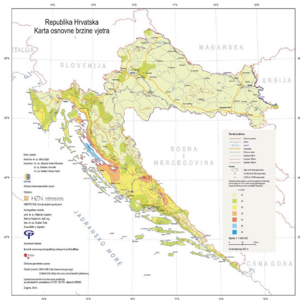
Slika 5.4 - Karta osnovnih brzina vjetra v_{b,0}
