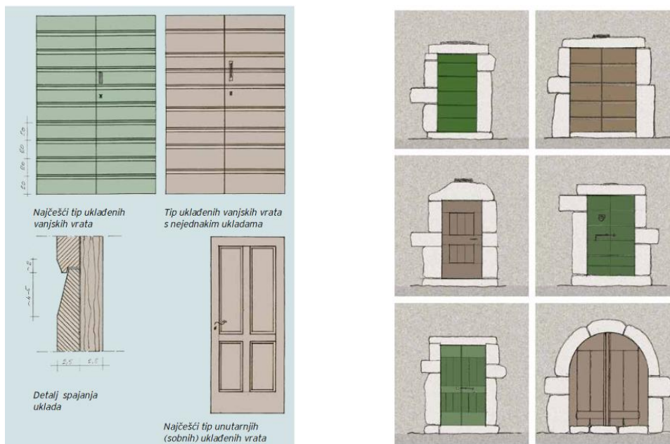
Skica 16: Izvedba stolarije na staroj kamenoj kući [4]
