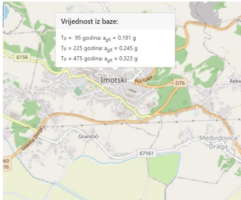
Fotografija 45: Karta RH potresna područja sa vršnim ubrzanjem tla s vjerovatnošću premašaja 10% u 10 godina za povratno razdoblje od 95 godina, sa iskazanim vrijednostima iz baze [16]
