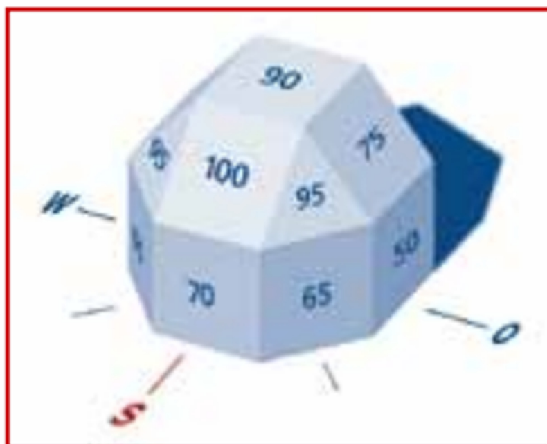
Slika 12 Efikasnost solarnog panela s obzirom na njegov nagib i pozicioniranje prema stranama svijeta [6]
