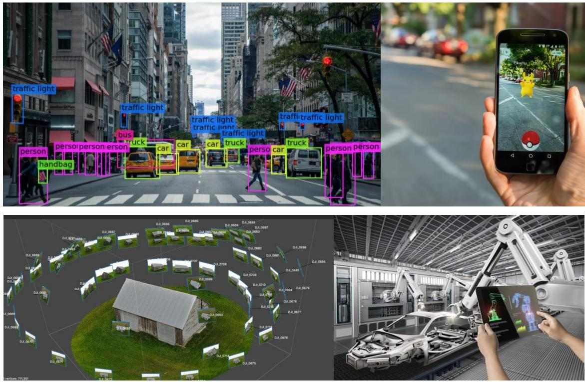
*Slika 3: Primjena korištenja računalnog vida - YOLO otkrivanje i klasifikacija više objekata, proširena stvarnost, fotogrametrija, kontrola robota*
