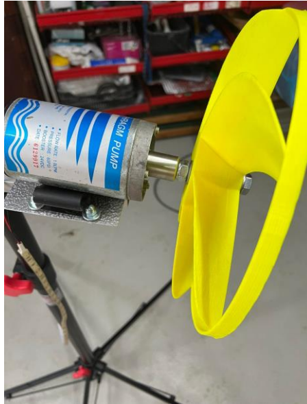
Slika 4.6. Montiranje prve verzije lopatica na osovinu generatora
