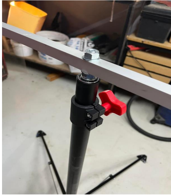
Slika 4.4. Spajanje četvrtaste cijevi sa mehanizmom za okretanje postrojenja
