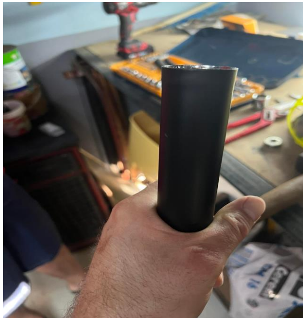
Slika 4.2. Izrada zadebljanja nosećeg stupa vjetroagregata
