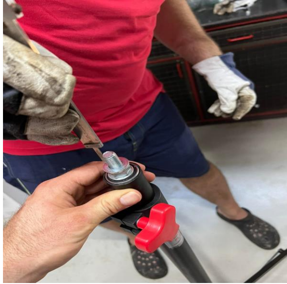
Slika 4.3. Sastavljanje mehanizma za okretanje postrojenja
