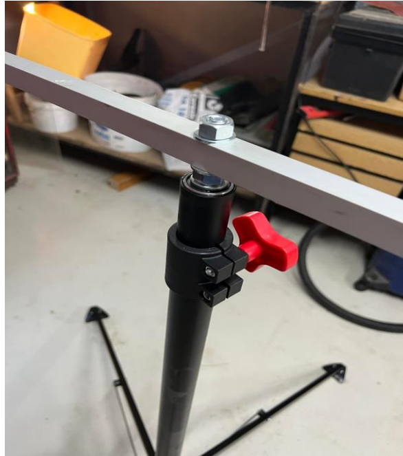
Slika 4.4. Spajanje četvrtaste cijevi sa mehanizmom za okretanje postrojenja
