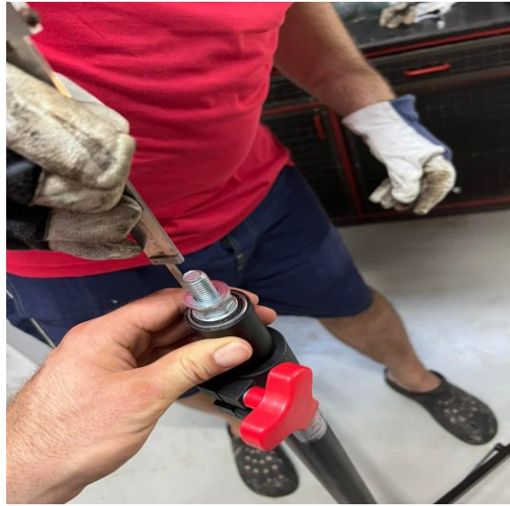
Slika 4.3. Sastavljanje mehanizma za okretanje postrojenja
