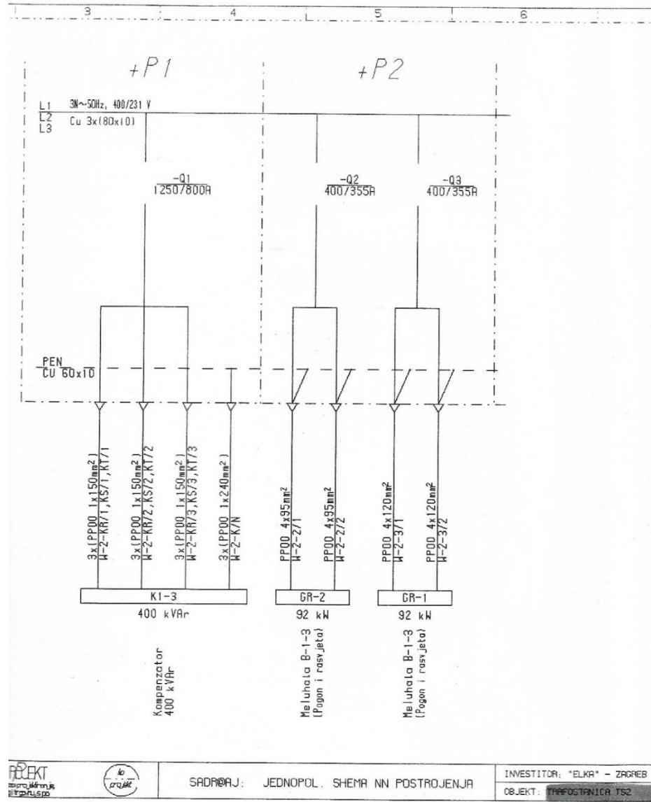
Slika 19. Jednopolna shema kompenzacijskog ormara TS2 [8]
