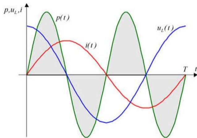
Slika 4. Krivulja struje, napona i snage na zavojnici [1]
