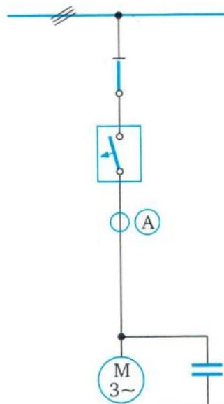
Slika 12. Pojedinačna kompenzacija, jednopolna shema [5]
