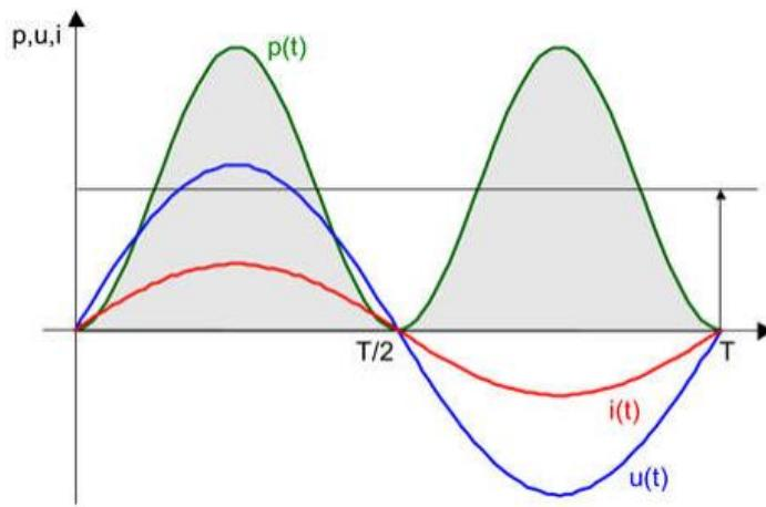
Slika 2. Krivulje napona, struje i snage na otporniku [1]
