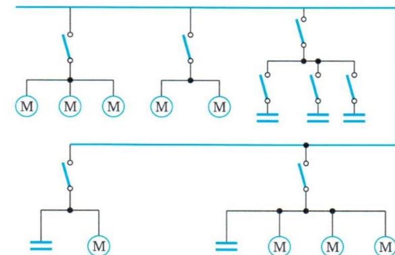
Slika 20. Shematski prikaz mješovite kompenzacije, koja se sastoji od pojedinačne, grupne i centralne kompenzacije [5]
