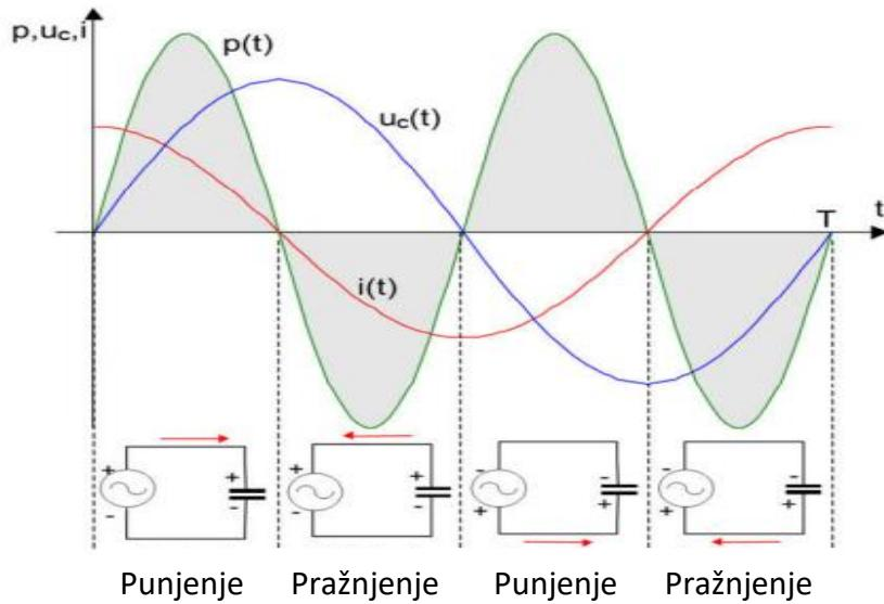
Slika 3. Krivulja struje, napona i snage na kondenzatoru [1]
