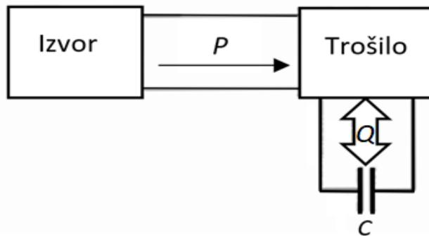
Slika 6. Izmjena jalove snage između induktivnog trošila i kondenzatora [4]
