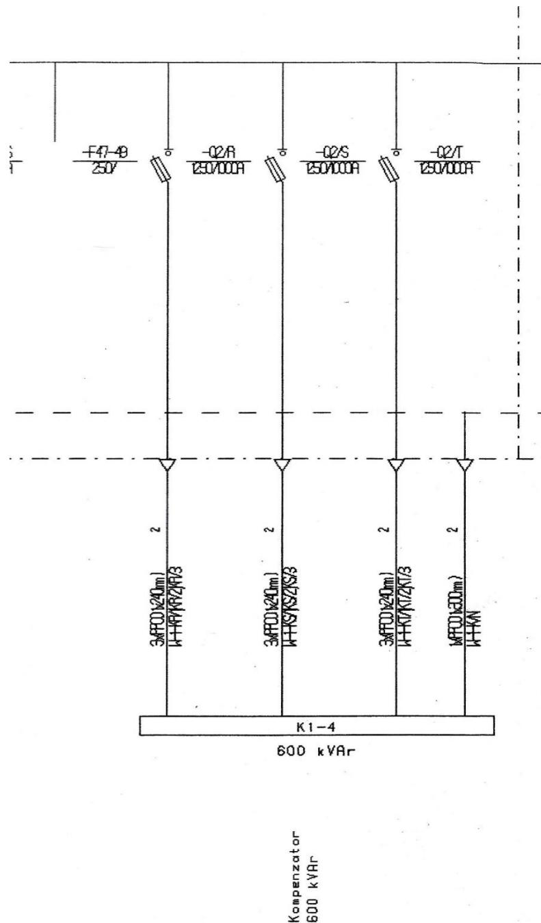
Slika 17. Jednopolna shema kompenzacijskog ormara TS1 [8]
