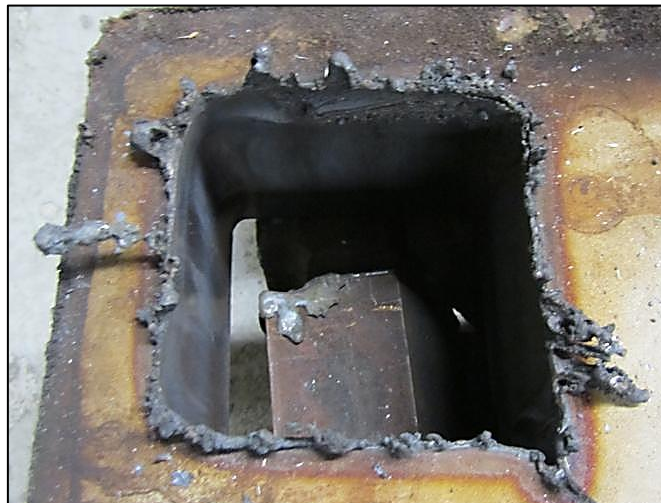
Slika 3.3.3. Nakupljena šljaka na površini ploče [15]
