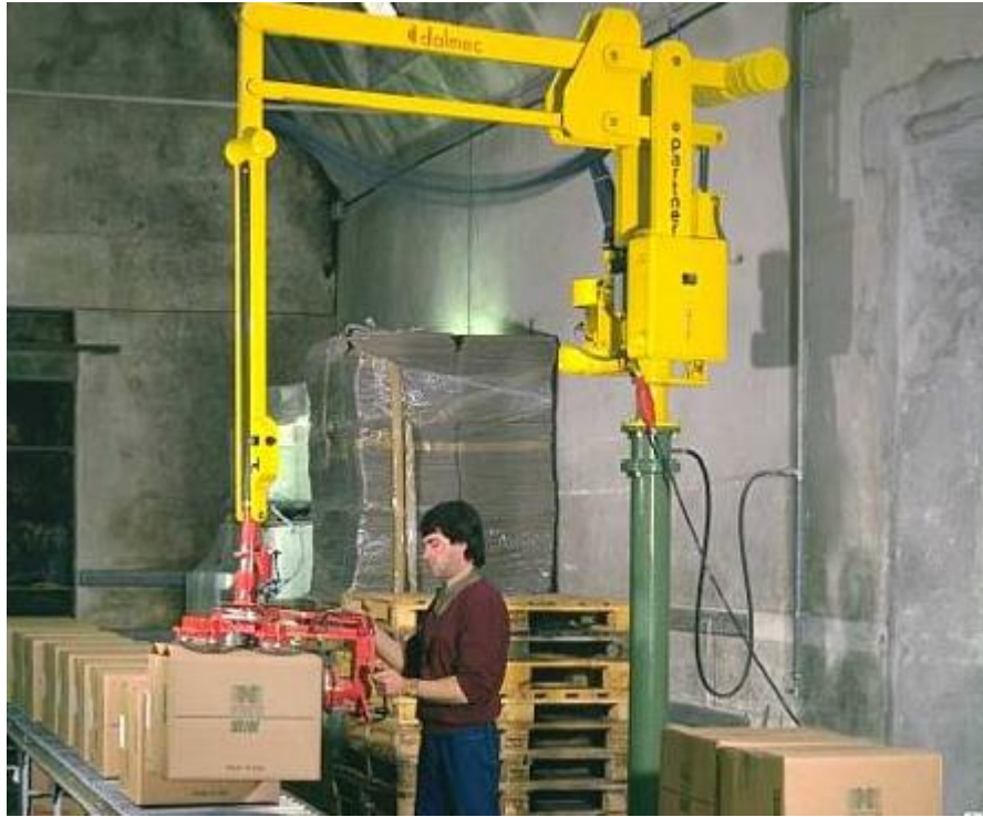
Slika 1.1. Pneumatski manipulator tereta [2]
