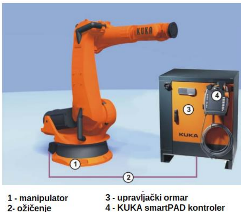
Slika 6.1. Dijelovi KUKA KR 180 R3200 PA robota [22]
