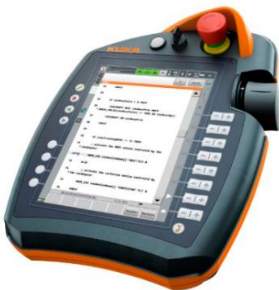
Slika 6.5. KUKA SmartPAD kontroler [25]
