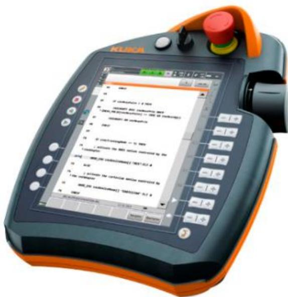
Slika 6.5. KUKA SmartPAD kontroler [25]
