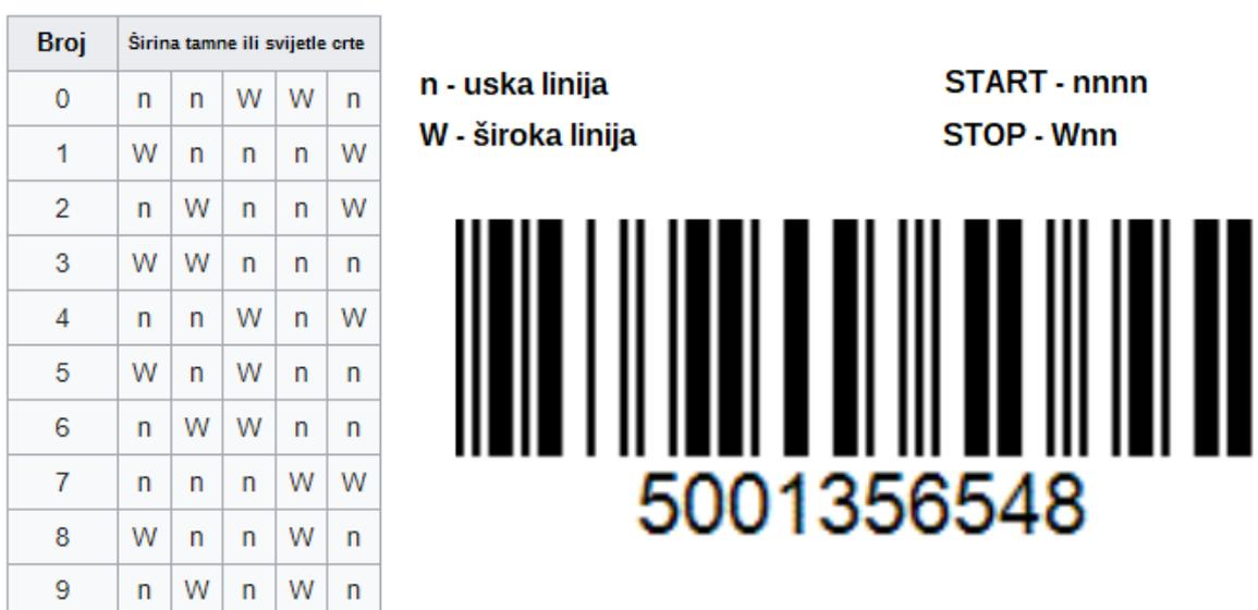
Slika 7.1. Interleaved 2/5 bar kod
