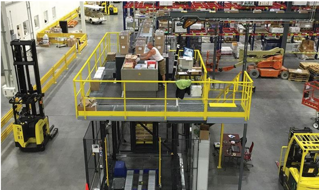
Slika 9.2. Poluautomatski „layer by layer“ paletizer kutija različitih dimenzija [30]
