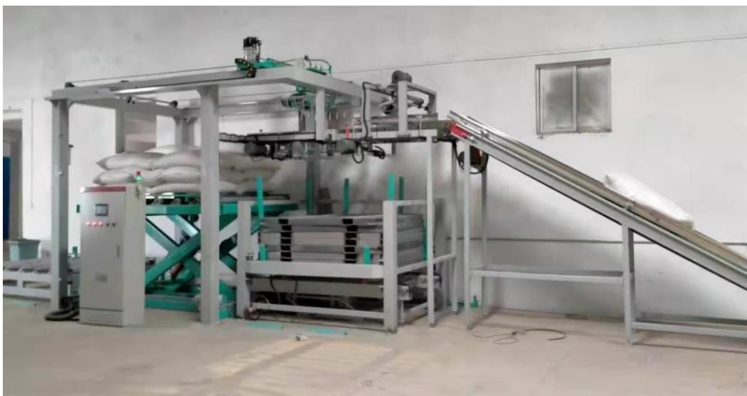
Slika 9.3. Automatski „layer by layer“ paletizer vreća [31]
