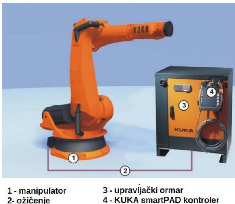
Slika 6.1. Dijelovi KUKA KR 180 R3200 PA robota [22]
