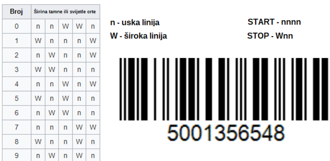
Slika 7.1. Interleaved 2/5 bar kod
