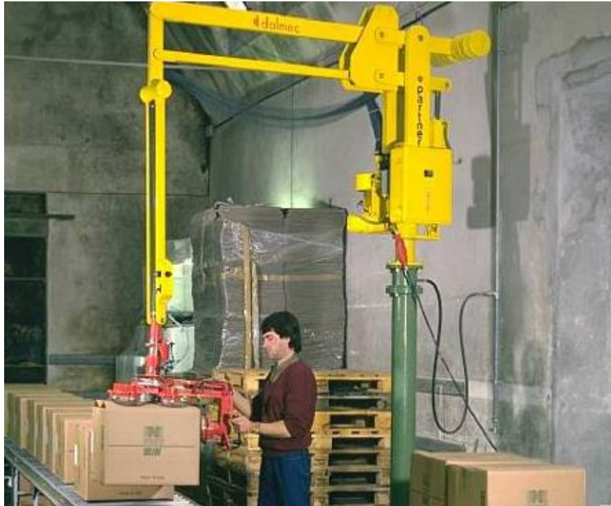
Slika 1.1. Pneumatski manipulator tereta [2]
