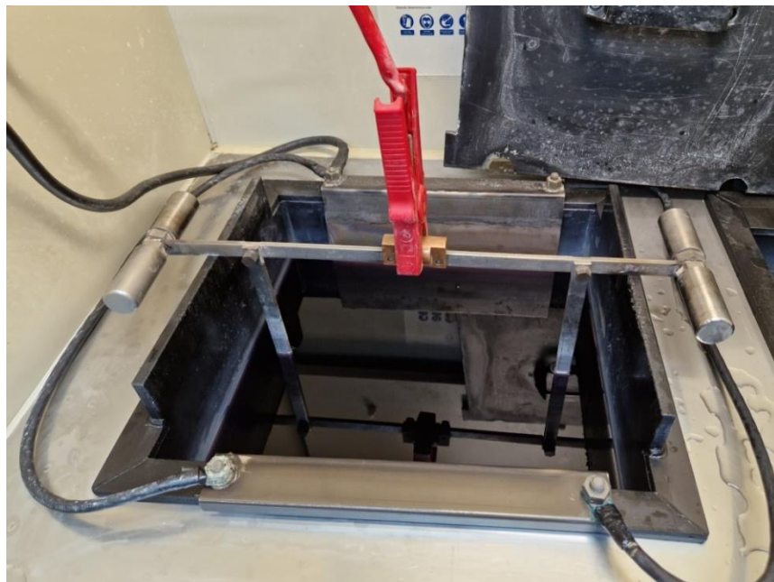
Slika 25. Pričvršćivanje spojnice na stalak
