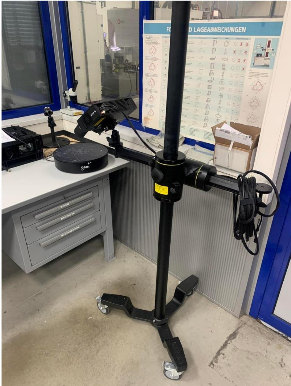
Slika 43. Skener Atos Q8 s postoljem
