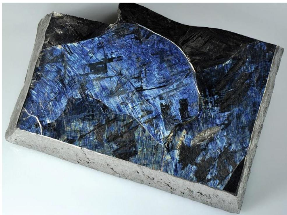
*Slika 1. Metalni titan visoke čistoće 99,999% [3]*
