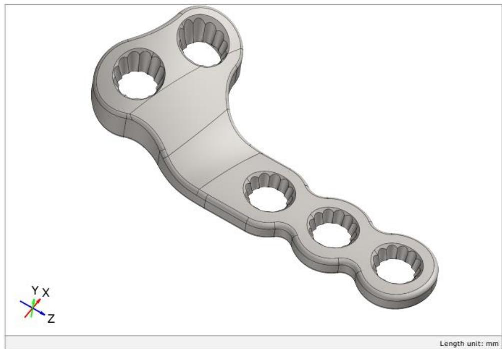
Slika 46. Model skenirane pločice
