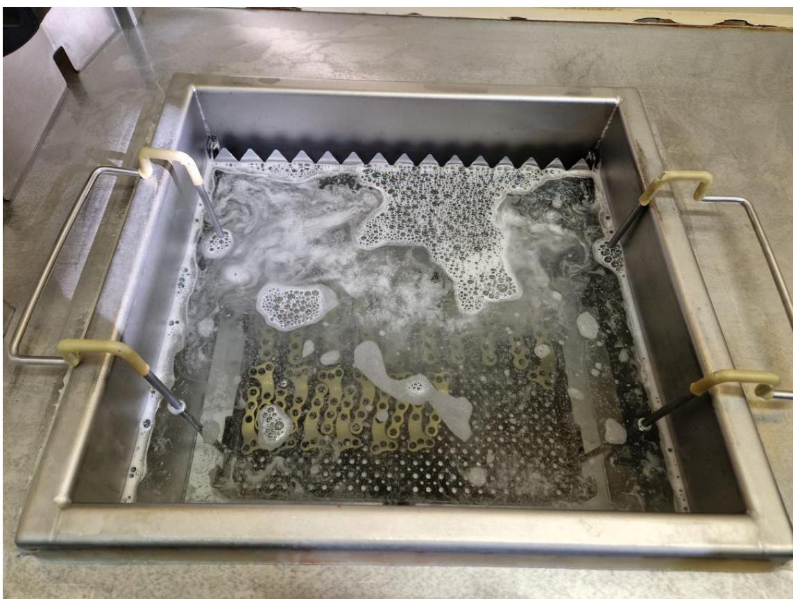
*Slika 32. Kratkotrajno pasiviranje*
