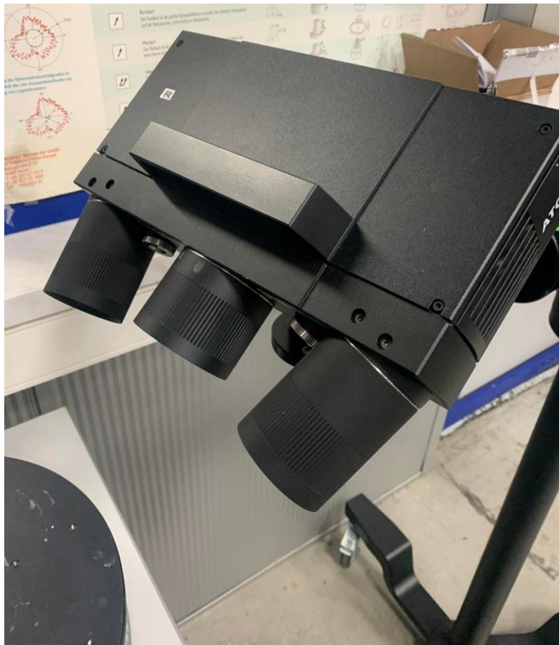
Slika 44. Skener Atos Q8
