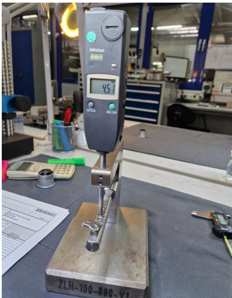
Slika 42. Mjerenje rupa ("cvjetova")
