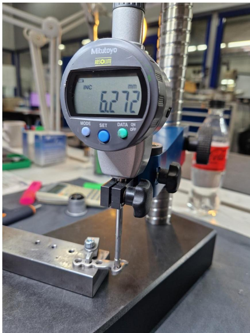
Slika 37. Mjerjenje visine kuglice
