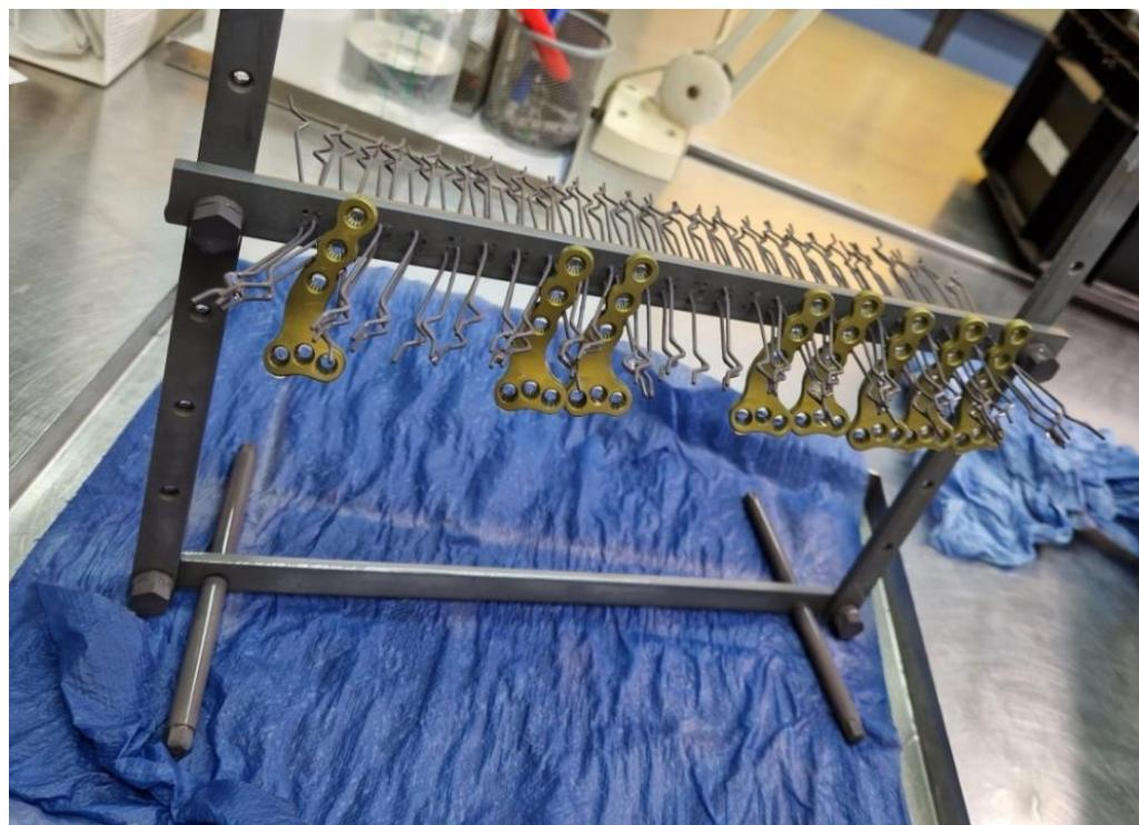
Slika 27. Anodizirane pločice
