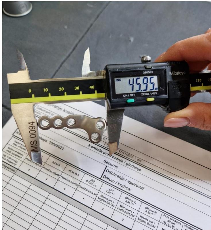
Slika 38. Mjerenje pomičnim mjerilom
