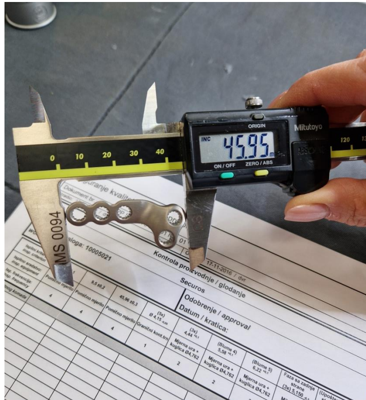
Slika 38. Mjerenje pomičnim mjerilom
