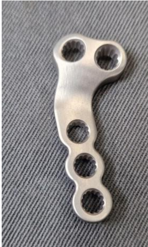
Slika 20. Pločica nakon kugličarenja
