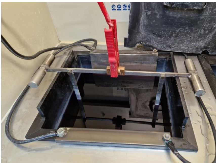
Slika 25. Pričvršćivanje spojnice na stalak
