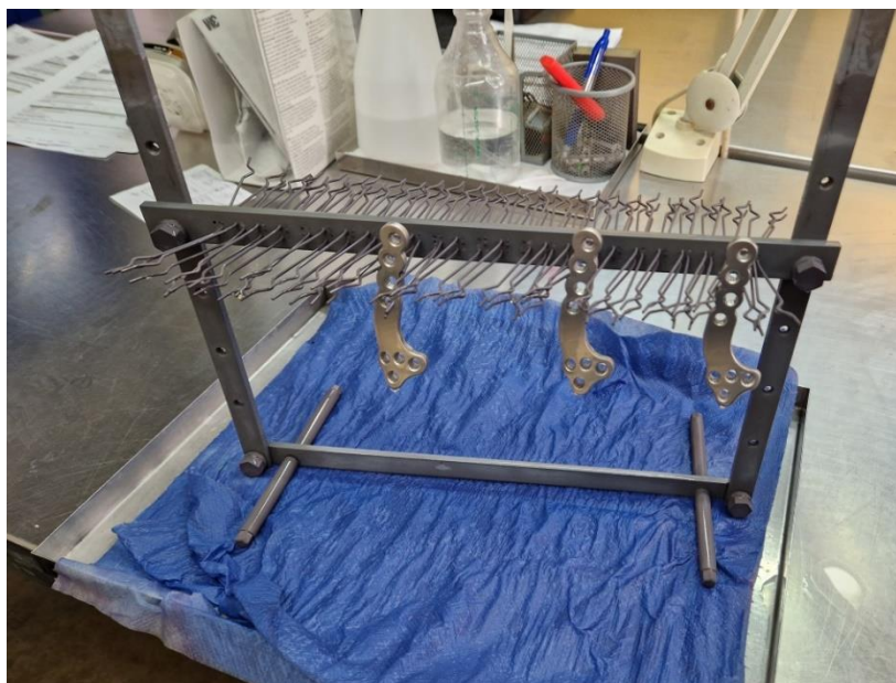
Slika 24. Stalak za anodiziranje
