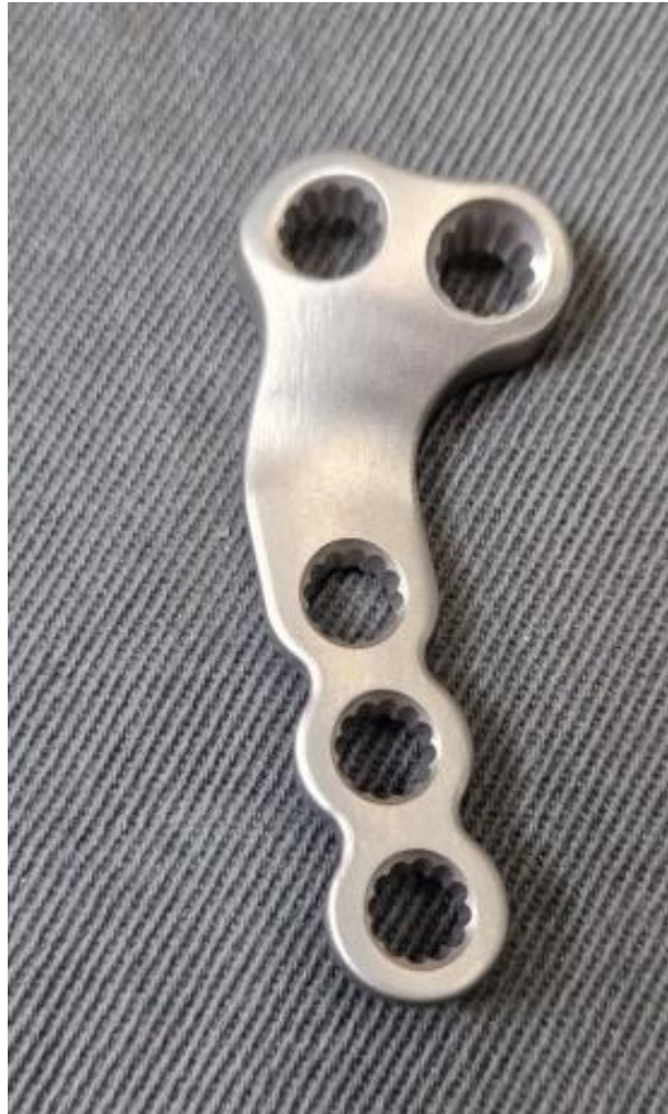
Slika 20. Pločica nakon kugličarenja
