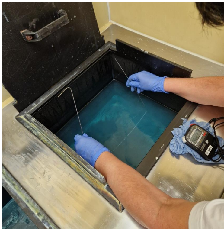
Slika 22. Postavljanje vremena za bajcanje
