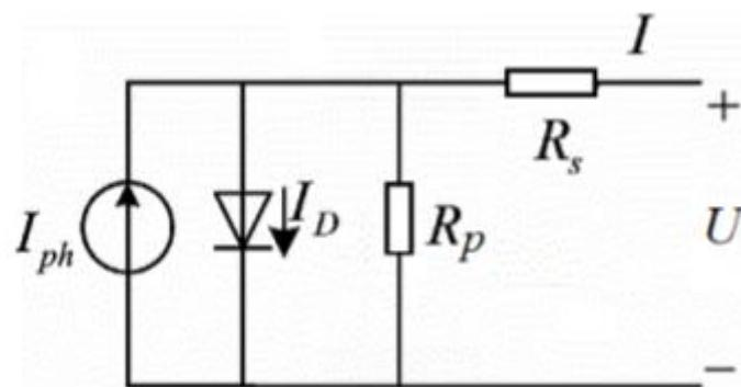
Slika 5.2. - Shema jednodiodnog modela fotonaponske ćelije
