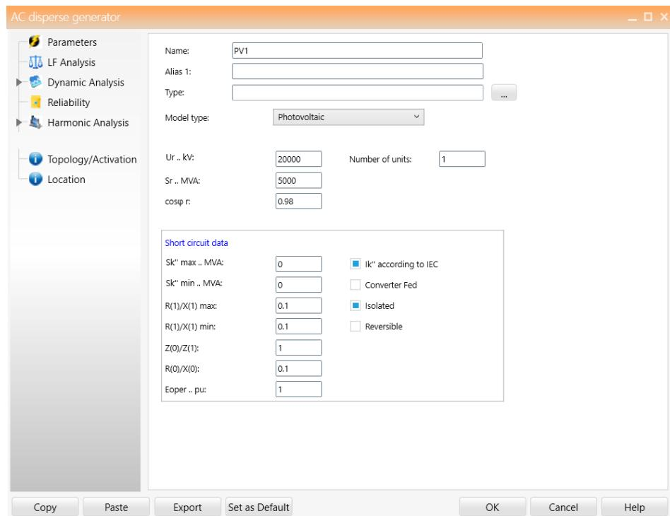
Slika 6.3. - Parametri solarnih elektrana
