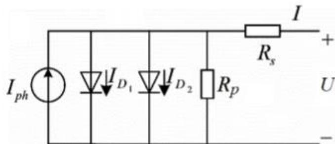
Slika 5.1. - Shema dvodiodnog modela fotonaponske ćelije
