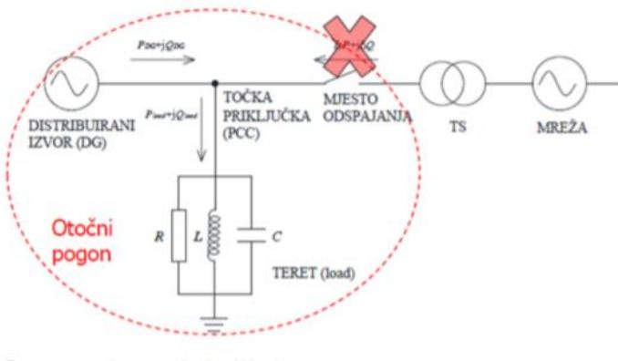
Slika 2.1. - Prikaz otočnog pogona
