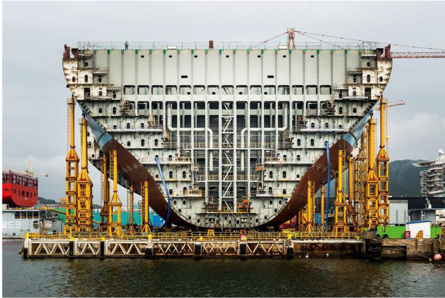
Slika 15: Konstrukcija broskog trupa
