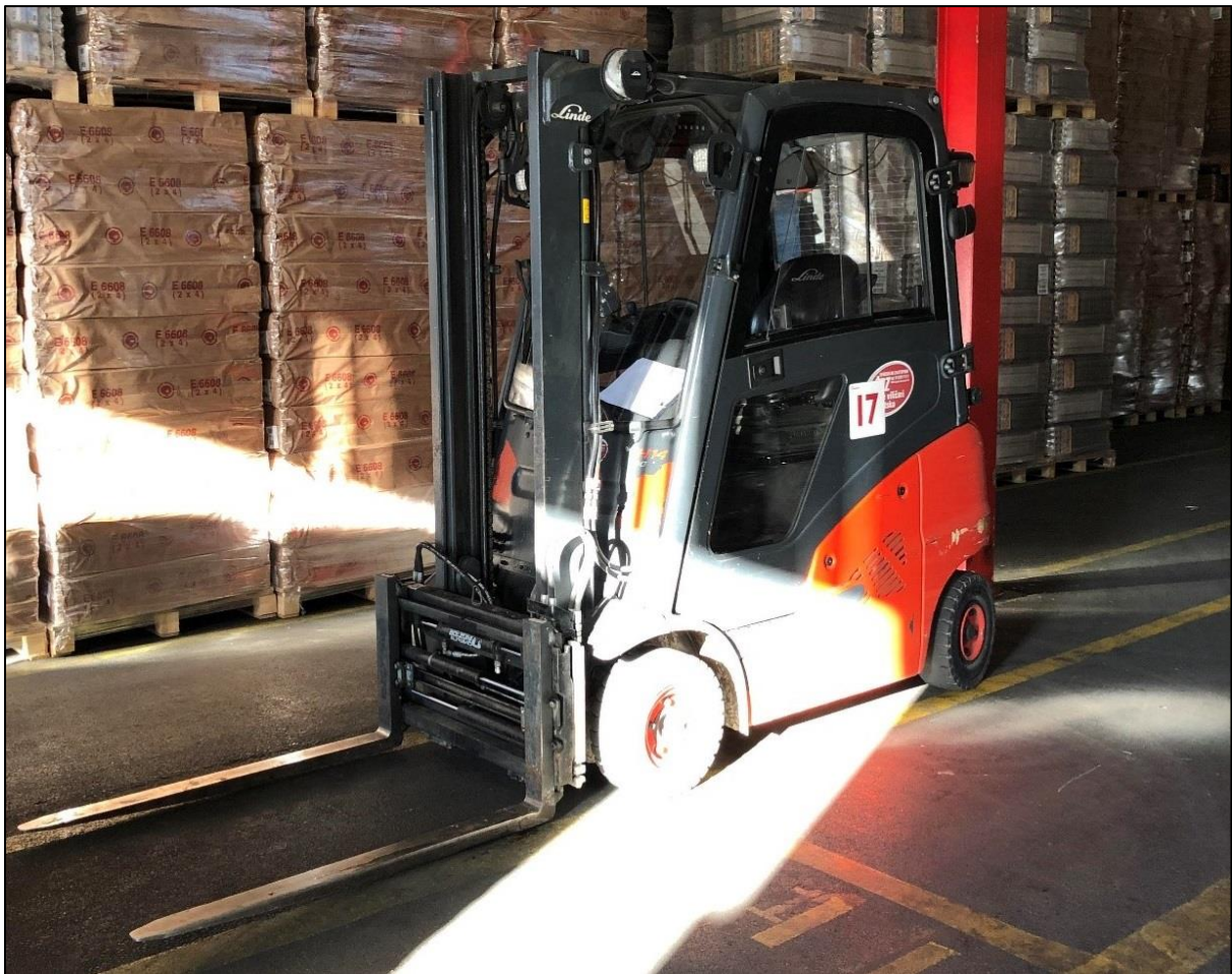
Slika 4.7. Čeoni viličar na plinski pogon
