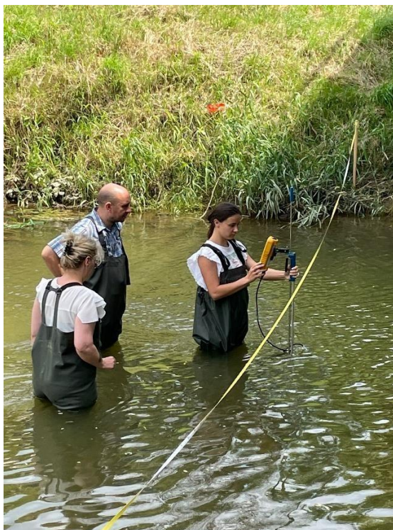
Slika 5.18. Hidrometrija u rijeci Bednji
