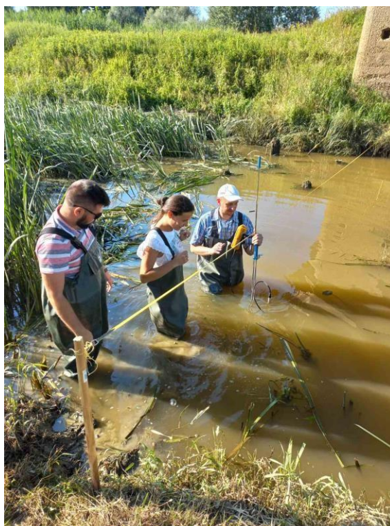
Slika 5.13. Hidrometrija na 0+002,50 m od lijeve obale rijeke Česme
