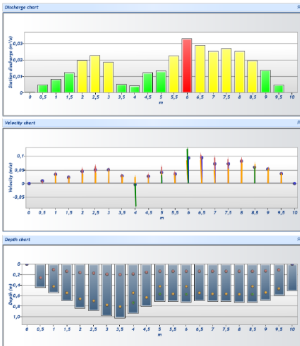
Slika 6.2. Grafički prikazi rezultata mjerenja u naselju Narta – prikaz protoka, brzina i dubina na svakoj mjernoj stanici
