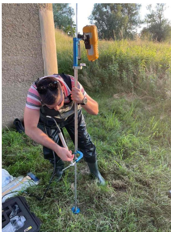
Slika 5.12. Sastavljanje hidrometrijskog uređaja za mjerenje na lokaciji rijeke Česme
