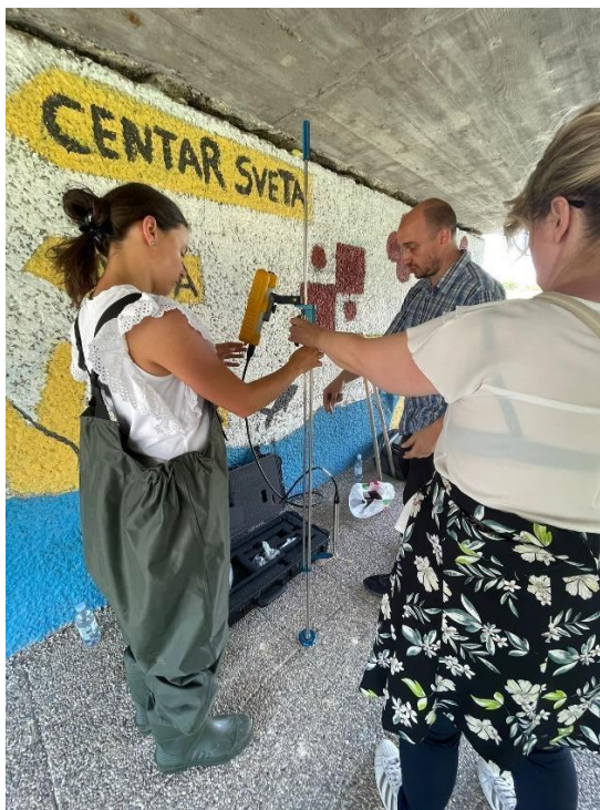
Slika 5.17. Sastavljanje hidrometrijskog uređaja na lokaciji rijeke Bednje
