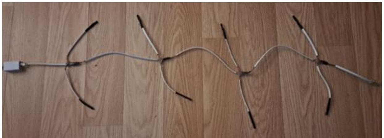
Slika 3.24. Realni model spojenih senzora topline dužine 1 metar
