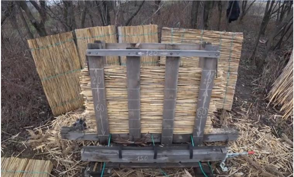
Slika 3.8. Prikaz staromodnog stroja za izradu ploča od trske [3]
