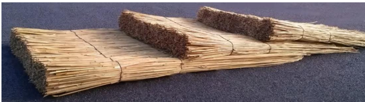
Slika 3.9. Princip slaganja i gradnje sa blokovima od trske [3]
