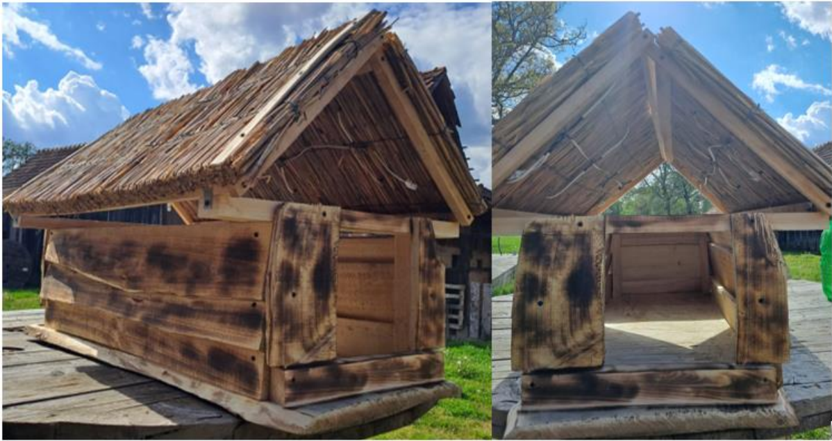
Slika 3.29. Prikaz makete kućice sa pločama od trske koje imitiraju krovište (slika lijevo) i prikaz kablova i spojenih senzora topline u krovu (slika desno)
