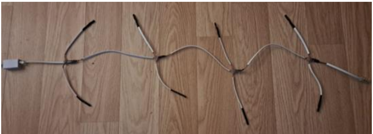
Slika 3.24. Realni model spojenih senzora topline dužine 1 metar
